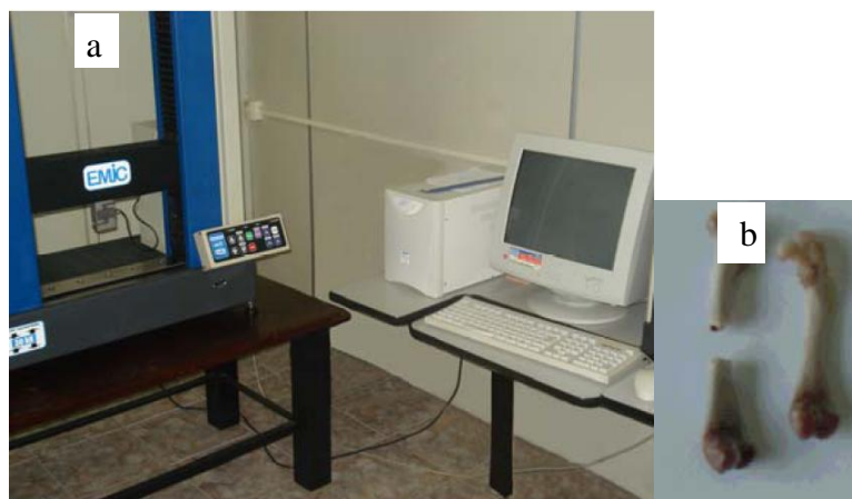
Figura 12. a Aparelho Universal de Ensaio EMIC ® acoplado a um computador. b Fêmur de ratas. Laboratório de Materiais Odontológicos e Prótese. Departamento de Odontologia. Unesp/Araçatuba-SP.
