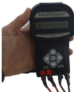
Figura 2.3. Medidor de condutividade elétrica aparente do solo modelo ERM-02, de fabricação da Landviser .
