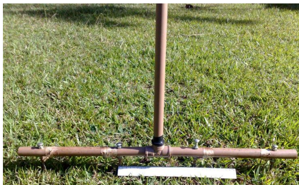
Figura 2.4. Configuração da Matriz de Wenner com espaçamentos entre eletrodos de 0,20 m.
