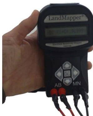
Figura 1.3. Medidor de condutividade elétrica aparente do solo modelo ERM-02, de fabricação da Landviser .
