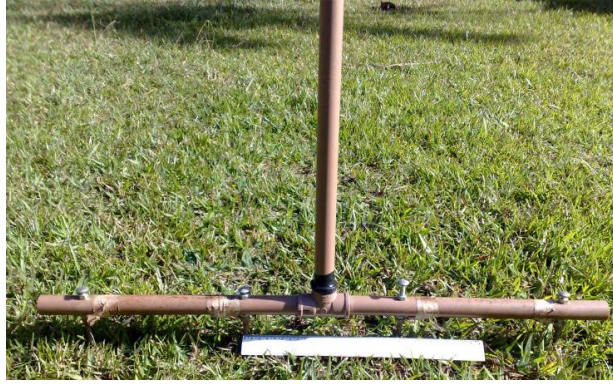
Figura 3.4. Configuração da Matriz de Wenner com espaçamentos entre eletrodos de 0,20 m.
