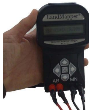
Figura 3.3. Medidor de condutividade elétrica aparente do solo modelo ERM-02, de fabricação da Landviser .
