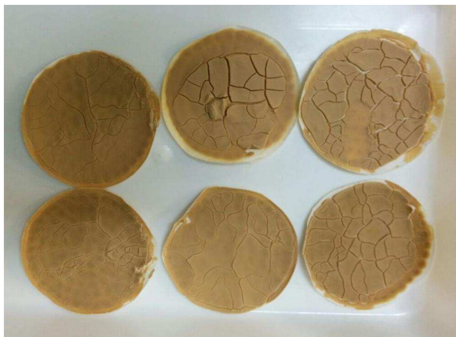
Figura A3. Precipitado HDL Mg-Fe filtrado após etapa de tratamento hidrotérmico.
