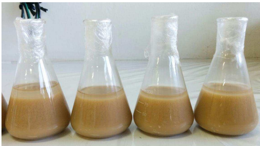
Figura A2. Suspensão HDL Mg-Fe após a síntese.
