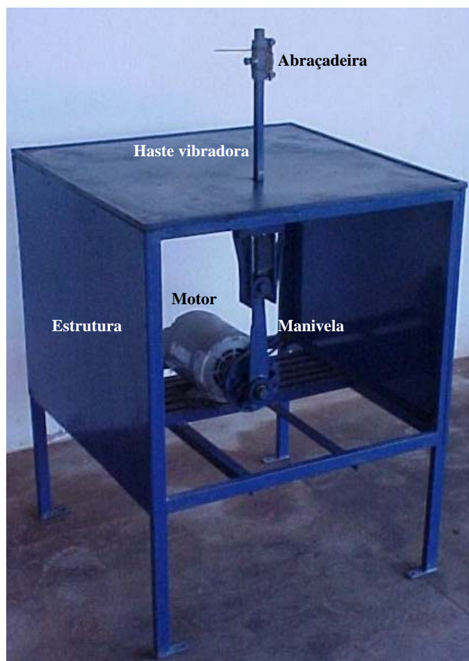
Figura 1 - Máquina construída para realização dos testes de vibração para derriça dos frutos do cafeeiro.
