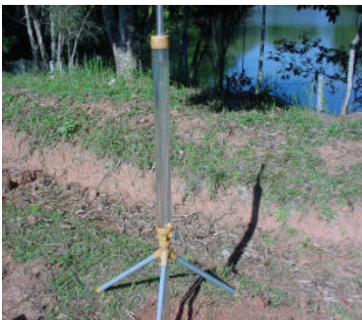
Figura 3.5 – Permeâmetro Guelph durante ensaio de campo
