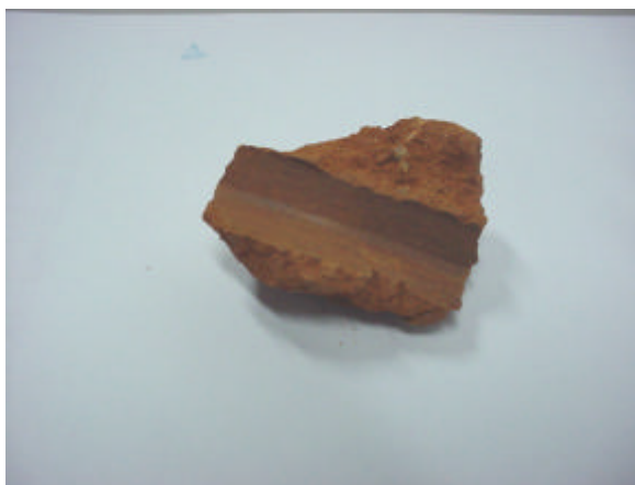
Figura 3.6 – Colmatação das paredes do furo pelo processo de tradagem
