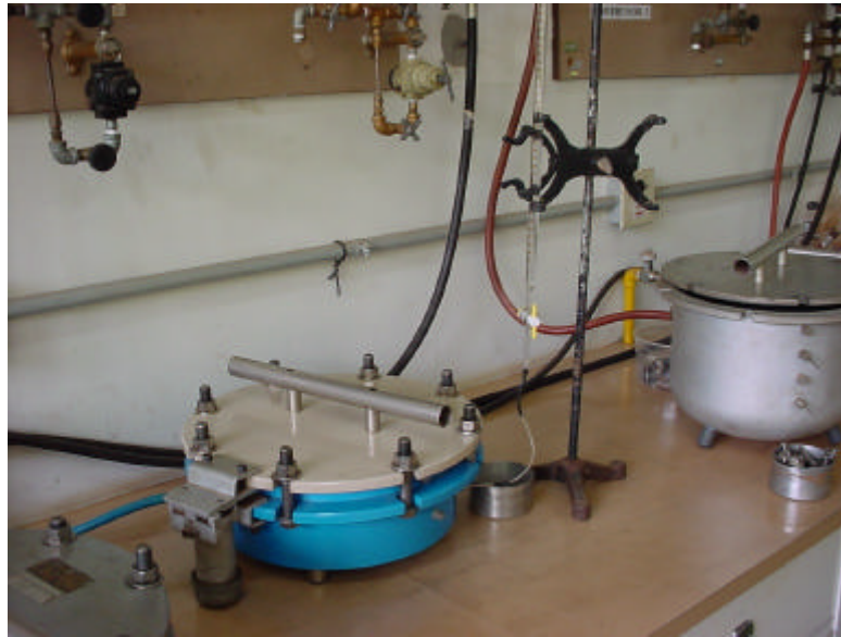
Figura 3.2 – Câmaras de pressão do Departamento de Solos utilizadas para obter as curvas de retenção
