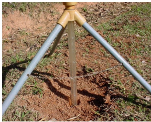
Figura 3.5 – Permeâmetro Guelph durante ensaio de campo
