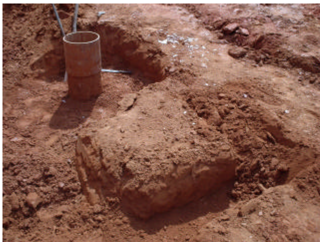
Figura 3.1 – Esquema de retirada das amostras indeformadas
