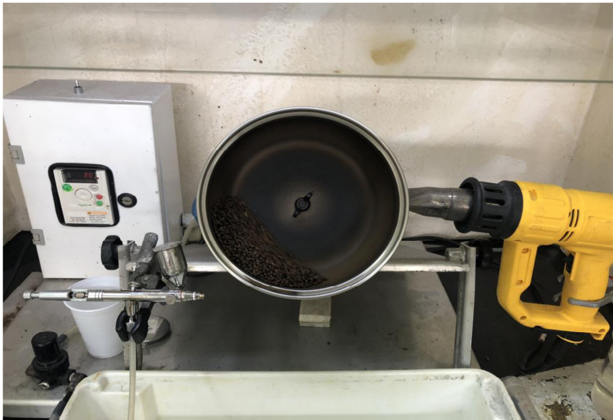
Figura 1: Prato granulador com pistola aquecedora e microspray para revestimento do fertilizante.
