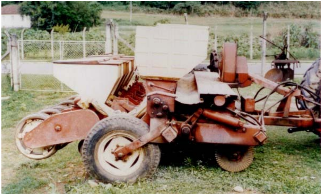
Figura 1 – Semeadora-adubadora Turbo-Max, utilizada no desenvolvimento do mecanismo de distribuição de calcário.
