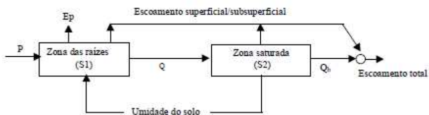
Figura 2 - Representação esquemática do balanço hídrico do solo no modelo semi distribuído TOPMODEL
