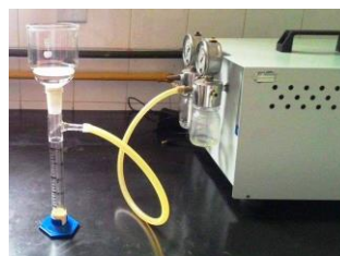
Figura 33 – Aparato para teste de resistência específica dos lodos
