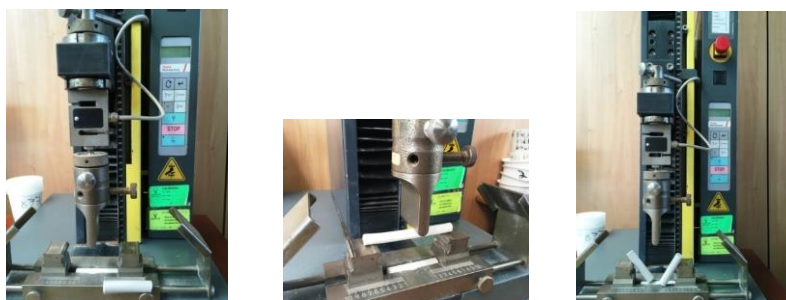
Figura 68 – Prensa utilizada nos ensaios de resistência à flexão de massas cerâmicas preparadas com lodo da ETA Peniche
