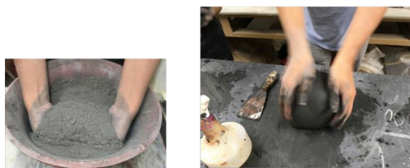
Figura 69 – Produção da massa cerâmica com lodo da ETA Peniche
