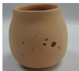
Figura 6 – Defeitos (furos e bolhas) em cerâmica incorporada com 15% de lodo de ETA
