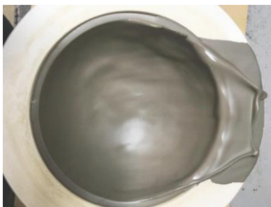
Figura 112 – Defeito (enrugamento) na superfície de peça produzida com a barbotina com lodo de sulfato de alumínio tratado devido à tixotropia excessiva
