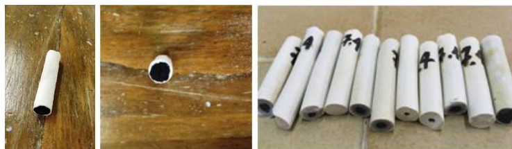
Figura 79 – Corpos de prova dos experimentos com lodo da ETA Peniche sinterizados a 1300°C e rompidos no ensaio de flexão, revelando o interior negro (defeito conhecido como “coração negro”)
