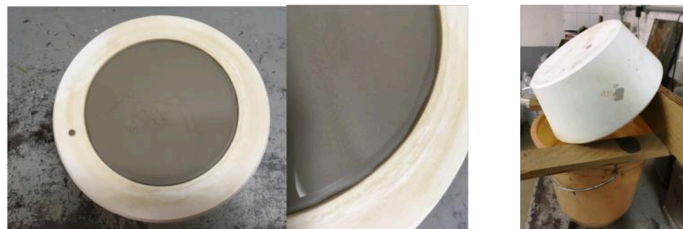
Figura 67 – Exemplo de teste de formação de parede da barbotina em molde de gesso (calota esférica)
