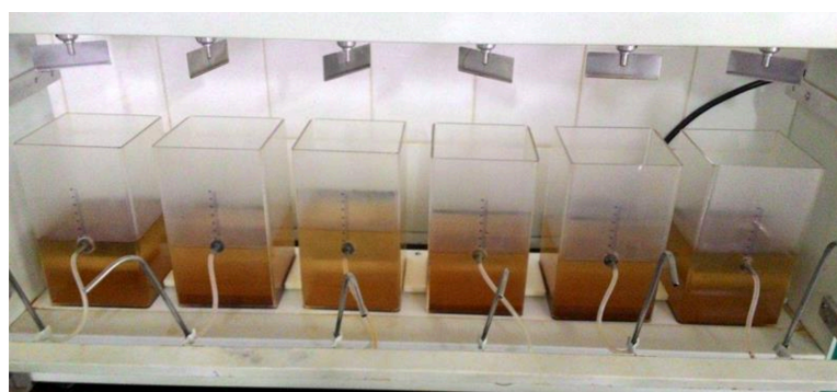
Figura 38 – Aspecto final do conteúdo dos jarros dos ensaios de condicionamento químico do lodo de cloreto férrico
