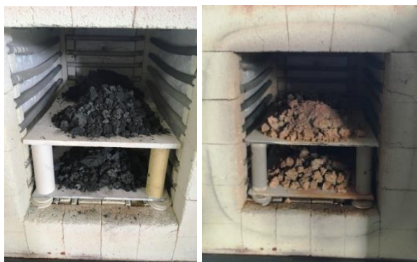
Figura 17 – Lodo da ETA Peniche antes (a esquerda) e após o tratamento térmico (a direita)
