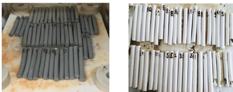
Figura 78 – Corpos de prova dos experimentos com lodo da ETA Peniche antes (esquerda) e após (direita) queima a 1000°C
