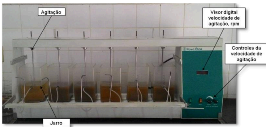
Figura 26 – Equipamento Jar test utilizado nos ensaios de condicionamento químico do lodo em bancada
