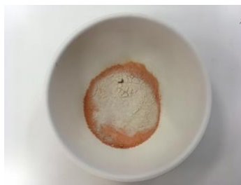
Figura 16 – Amostra de lodo calcinada a 1000°C por 2 h
