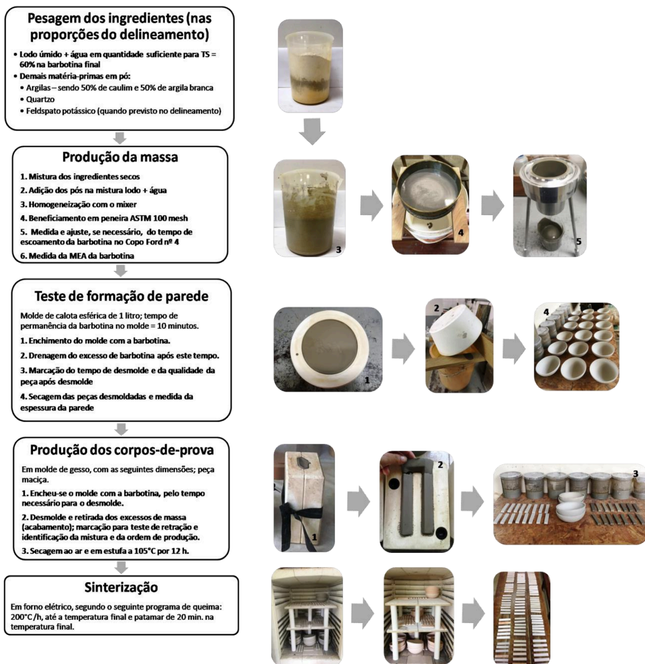
Figura 103 – Fluxograma do processo de produção das barbotinas e dos corpos de prova
