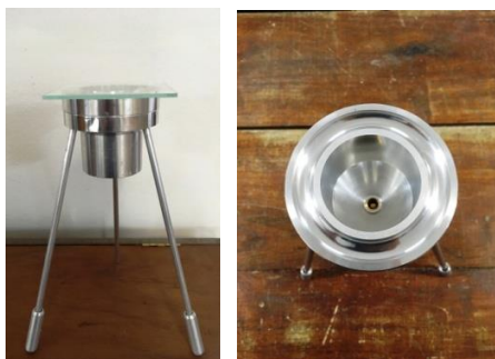
Figura 104 – Viscosímetro Copo Ford nº 4 utilizado no experimento – vista lateral (esquerda) e vista superior (direita) mostrando o orifício por onde o líquido escoar
