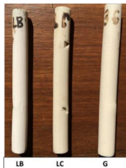
Figura 73 – Corpos de prova pós-queima para leitura de retração linear – LB: grês com lodo in natura ; LC: grês com lodo calcinado; e G: grês padrão
