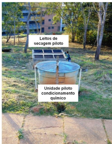
Figura 32 – Arranjo das unidades piloto para estudos de tratamento dos lodos – condicionamento químico e secagem
