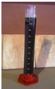
Figura 45 – Sobrenadante do tratamento químico do lodo de PAC em escala piloto
