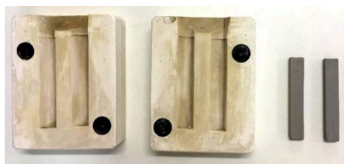
Figura 101 – Molde (aberto) utilizado na produção dos corpos de prova de barbotina
