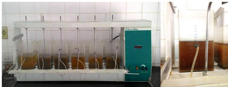
Figura 37 – Aspecto final do conteúdo dos jarros dos ensaios de condicionamento químico do lodo de sulfato de alumínio
