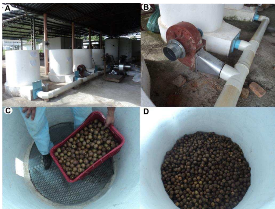
Figura I-15 Silo Armazenador-secador (A), ventilador radial (B), Enchimento dos silos (C e D)
