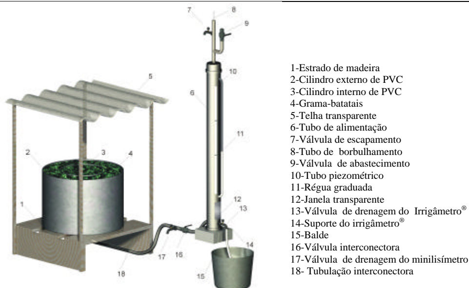
Figura 1 - Partes constituintes do minilísímetro com lençol freático constante e do Irrigâmetro ® modificado.
