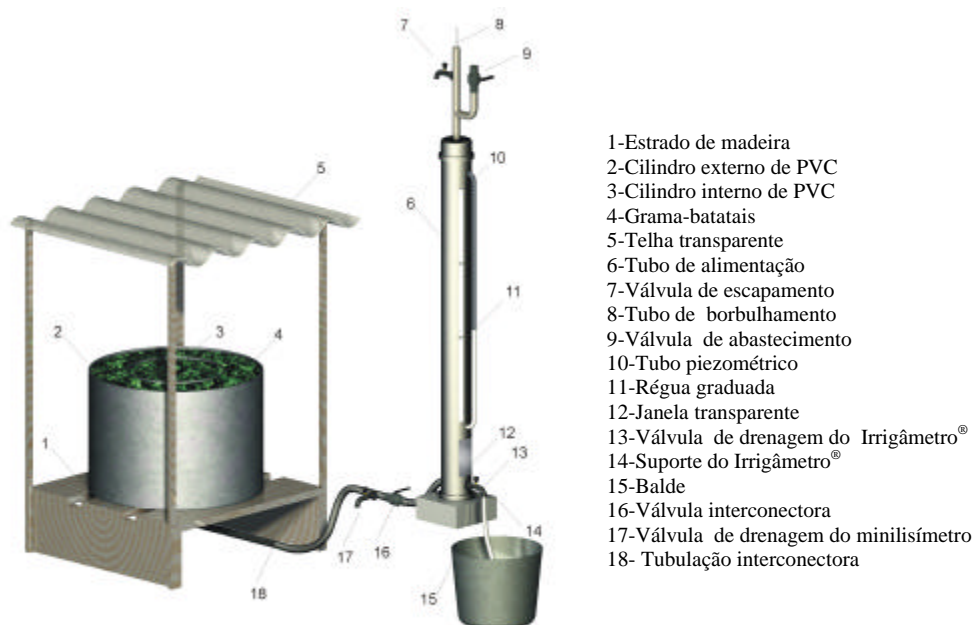
Figura 1 - Partes constituintes do minilímetro com lençol freático constante e do Irrigâmetro ® modificado.
