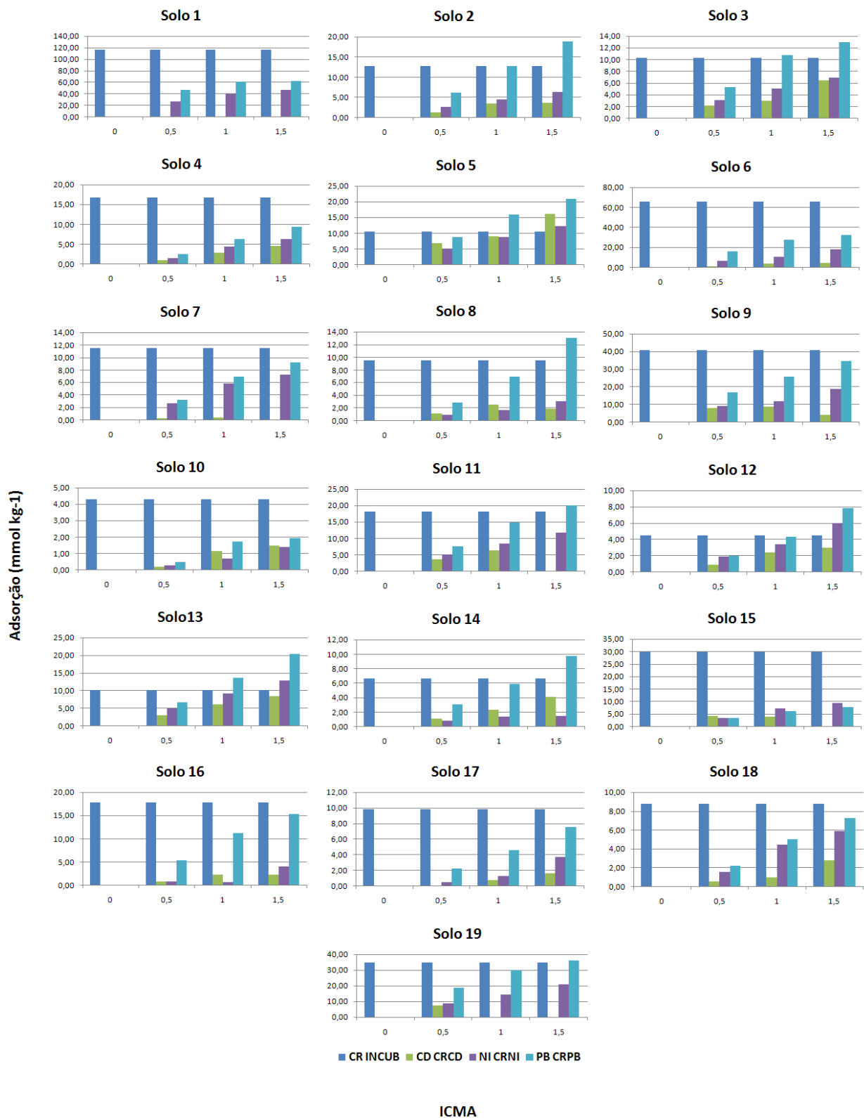
Figura 3. Adsorção de Cd, Ni e Pb em solos previamente incubados com doses equivalentes a Capacidade Máxima de Adsorção de Cr.
