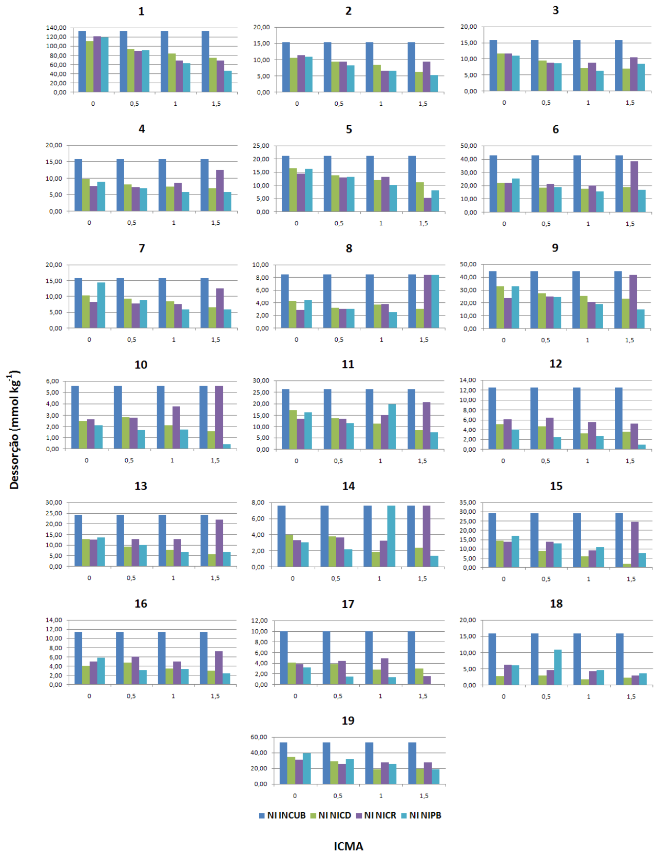
Figura 6. Dessorção do Ni previamente incubado em decorrência da aplicação de doses crescentes Cd, Cr e Pb.
