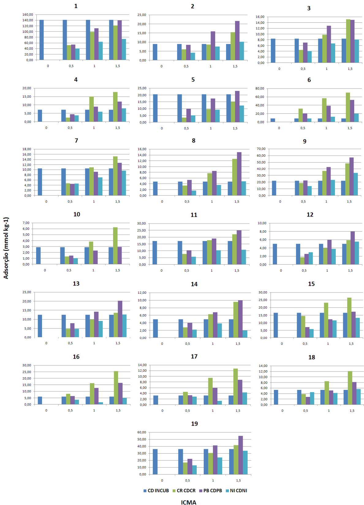
Figura 1. Adsorção de Cr, Pb e Ni em solos previamente incubados com doses equivalentes a Capacidade Máxima de Adsorção de Cd.
