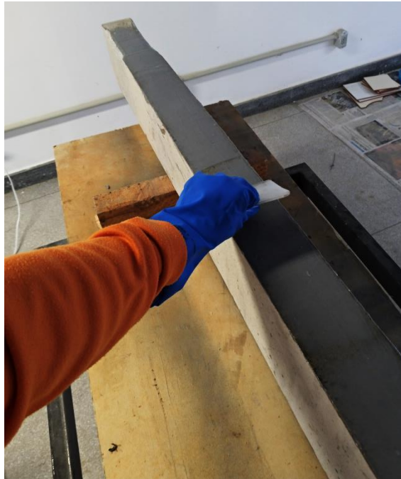
Figura 3.15 - Aplicação do adesivo MC-DUR 1209 TX.
