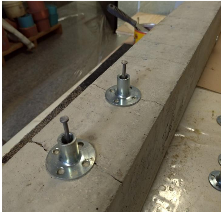
Figura 3.9 - Fixação dos bicos de adesão (a) e selamento das fissuras (b).
