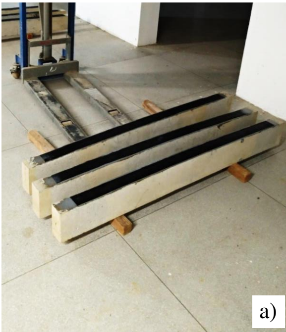
Figura 3.6 - Modelos reforçados sem ancoragem (a) e com ancoragem (b).
