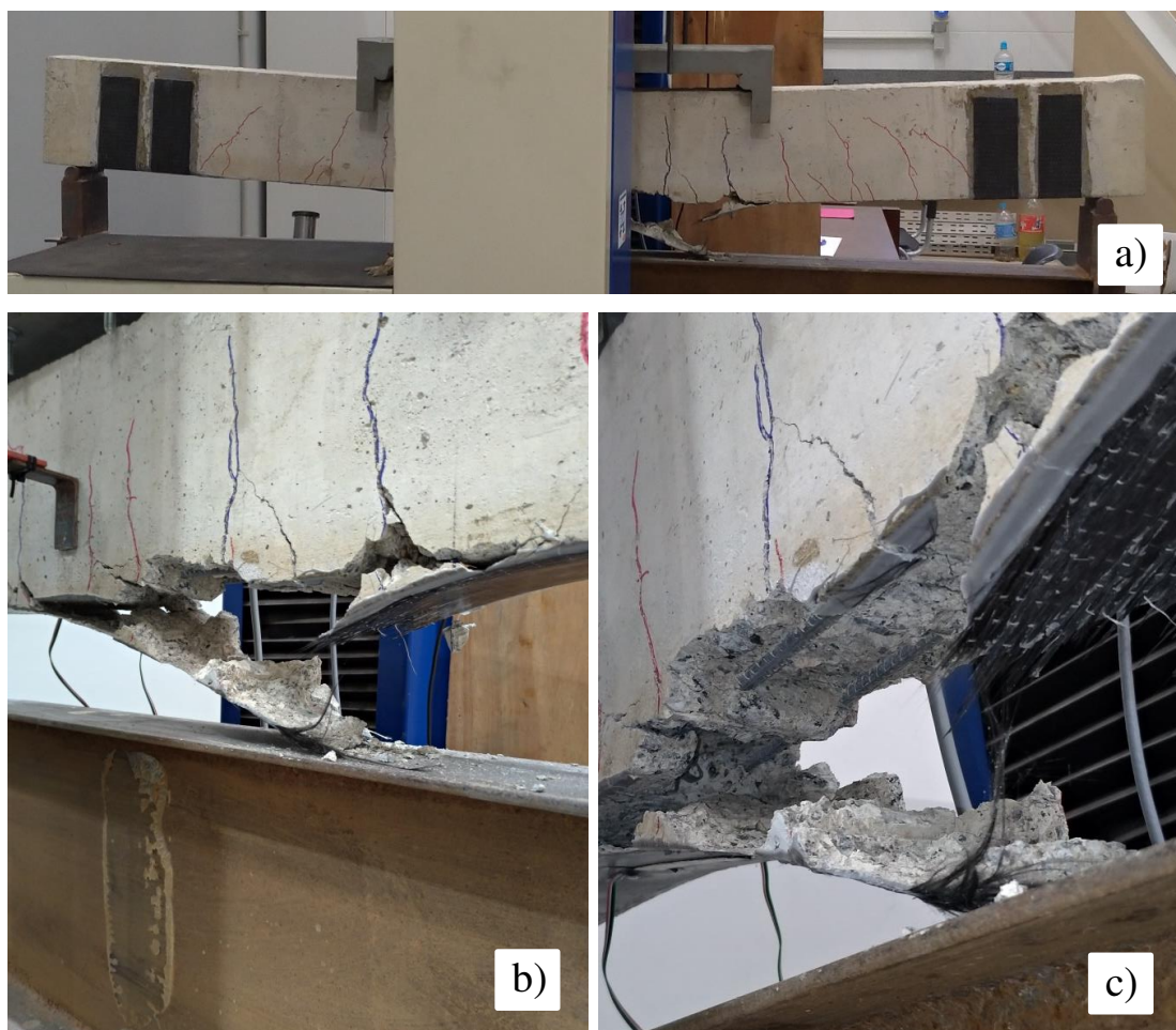
Figura 4.31 - a) Falha do modelo CRA63-NI. b) Detalhe do rompimento e descolamento da manta de CFRP. c) Detalhe do não rompimento da armadura positiva.
