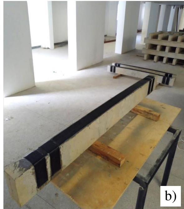
Figura 3.6 - Modelos reforçados sem ancoragem (a) e com ancoragem (b).
