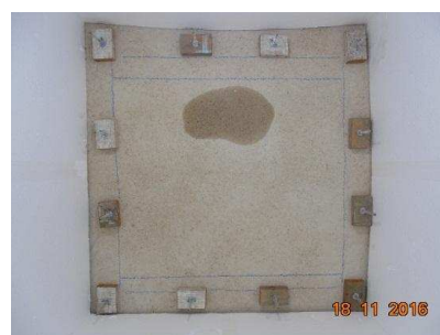
Figura 73 - Fotografias da evolução das áreas de manchas úmidas do ensaio no painel de traço 1:3:12 da Parede 2 adotando 144 Pa de pressão pneumática: (a) 1 h de ensaio – surgimento da 1ª mancha, (b) 3 horas, (c) 5 horas e (d) 7 horas de ensaio.
