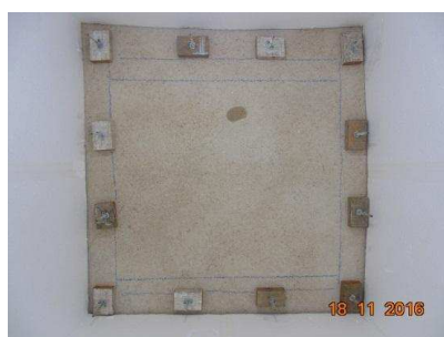
Figura 73 - Fotografias da evolução das áreas de manchas úmidas do ensaio no painel de traço 1:3:12 da Parede 2 adotando 144 Pa de pressão pneumática: (a) 1 h de ensaio – surgimento da 1ª mancha, (b) 3 horas, (c) 5 horas e (d) 7 horas de ensaio.
