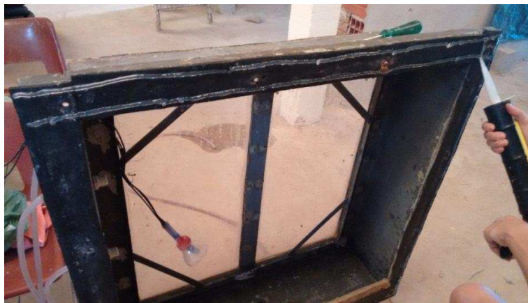
Figura 66 - Aplicação de feixes de silicone nas bordas da câmara.
