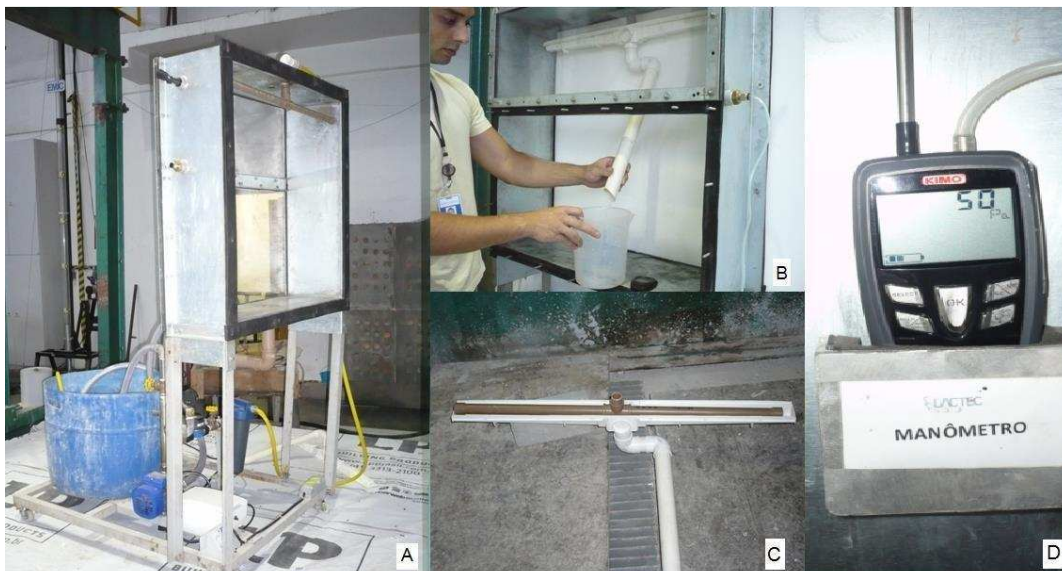
Figura 25 - Apresentação dos equipamentos envolvidos no ensaio de estanqueidade, reproduzindo a ABNT NBR 15757:2013: A – câmara simuladora de chuva; B – calha coletora da vazão do aspersor, propiciando uma aferição da vazão (detalhe em uso); C – calha coletora (detalhe do encaixecom o aspersor); D – manômetro diferencial.
