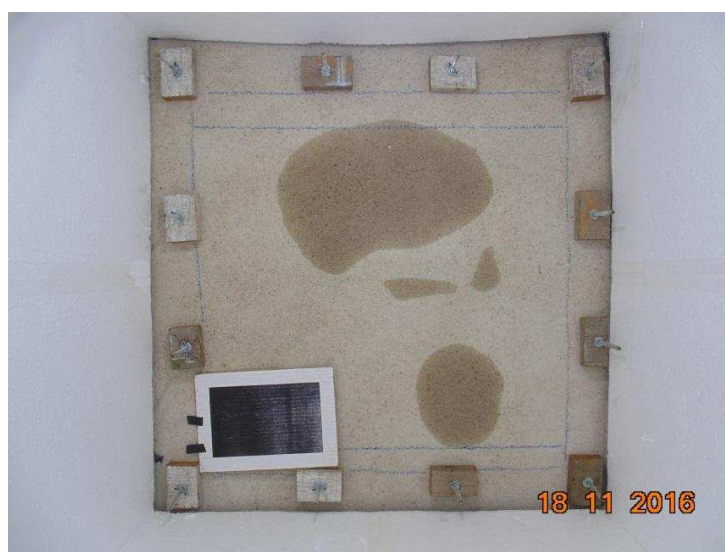
Figura 78 - Quadrado com dimensões conhecidas para calibrar método digital de contagem
