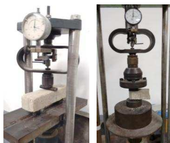
Figura 36 - Equipamento de medição da resistência (a) à tração na flexão e (b) à compressão.
