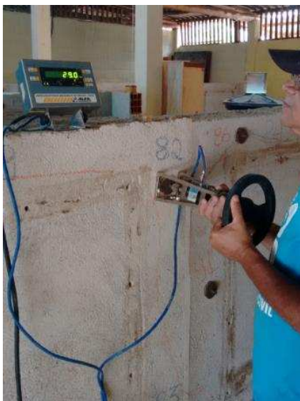
Figura 37 - Realização do ensaio de resistência de aderência à tração.
