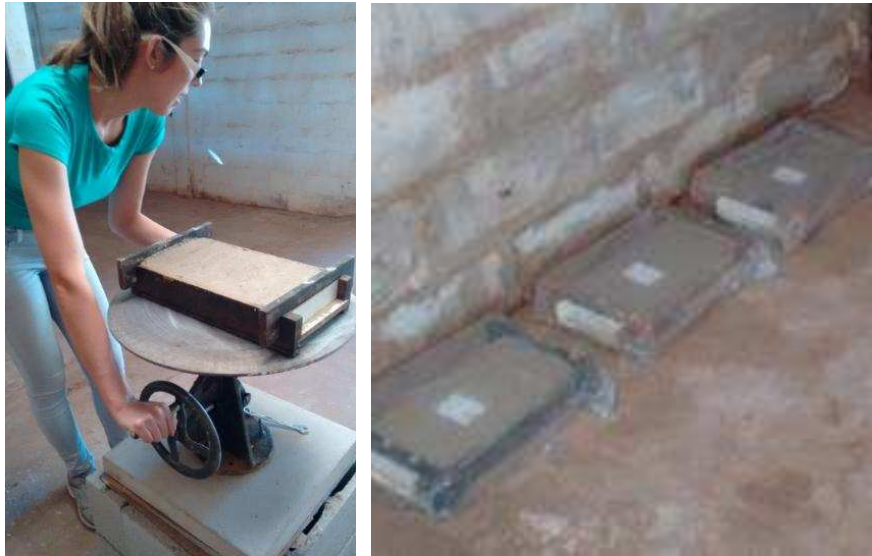
Figura 33 - Etapas do ensaio da moldagem dos corpos de prova: (a) acionamento da mesa de adensamento; (b) condicionamento dos corpos de prova em sacos plásticos.
