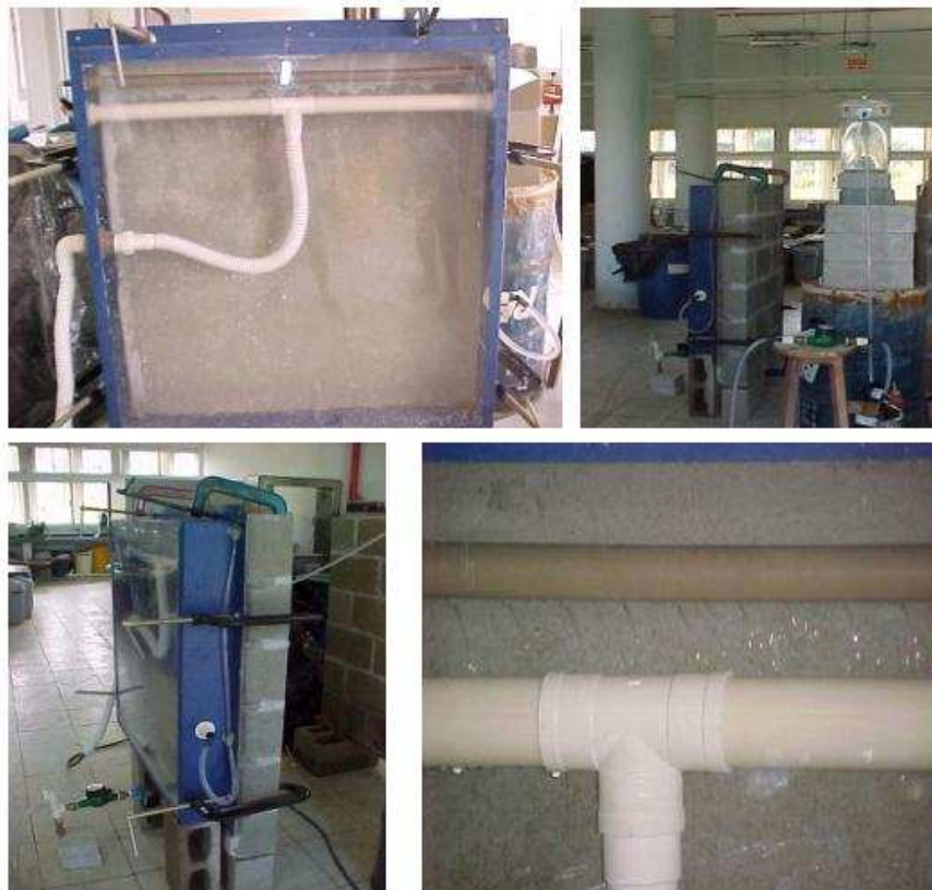
Figura 24 - Detalhes da câmara de estanqueidade e seu acoplamento aos corpos de prova, reproduzindo a ASTM E 514:2011, pelo ITP.
