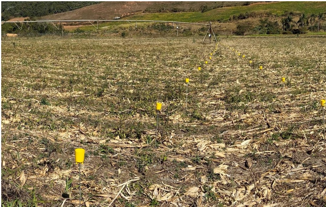
Figura 8 - Ensaio de precipitação a campo com emissores de placa defletora rotativa oscilante.
