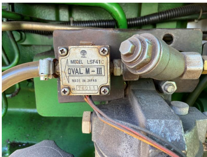
Figura 6 - Fluxômetro para determinação do consumo de combustível do trator.
