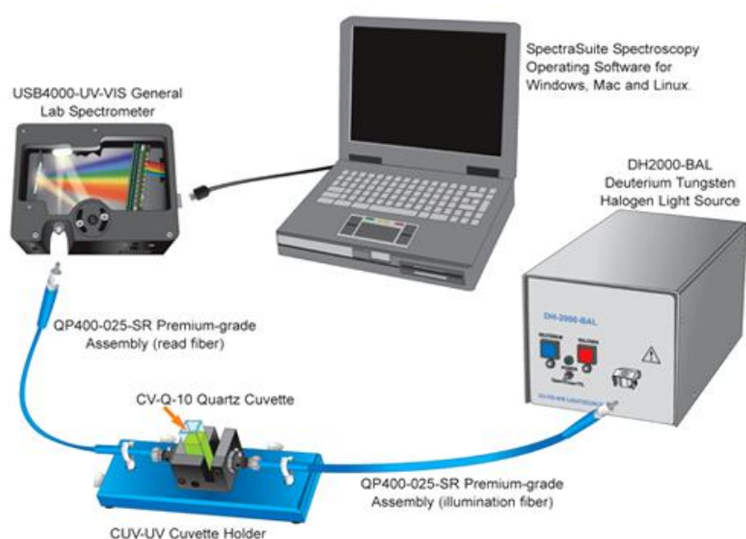
Figura 1.3. Esquema de montagem do sistema que utiliza um espectrógrafo multicanal compacto. FONTE: Ocean Optics [183].
