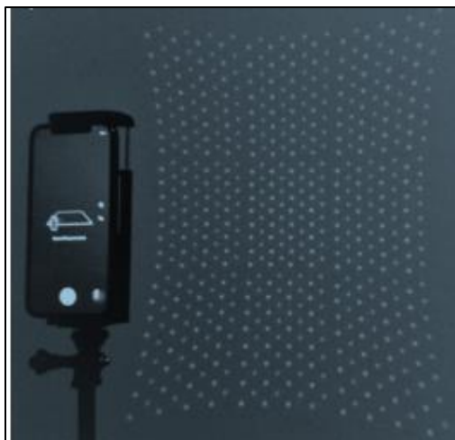
Figura 6 – Matriz de medição VCELS, totalizando 576 pontos.
