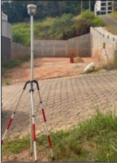
Figura 30 – a) Receptor estação base do RTK operando em modo estático; b) Croqui com a estação E0 e os pontos com o limite do lote.
