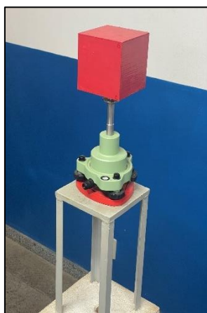
Figura 21 – Cubo montado em uma base nivelante, fixado em base de metal e concreto.
