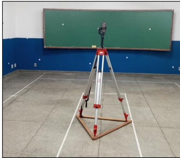
Figura 26 – Levantamento estático com iPhone 12 Pro fixado no estabilizador gimbal , apoiado no tripé.
