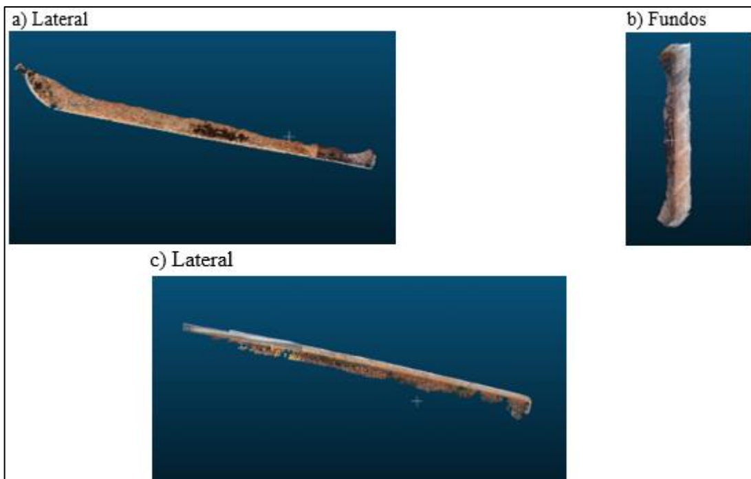
Figura 57 – Escaneamento por partes (3Lev), gerando 3 nuvens pelo smartphone .
