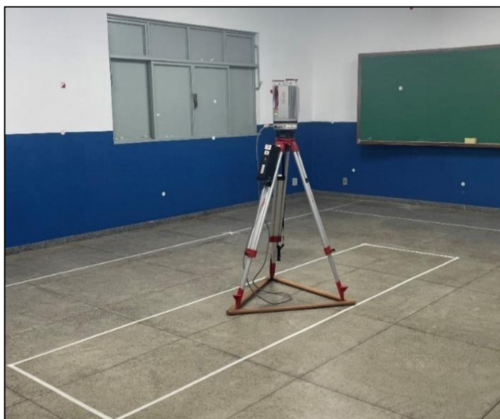
Figura 28 – Levantamento de referência utilizando o equipamento Laser Scanner Terrestre (LST), modelo VZ 400.
