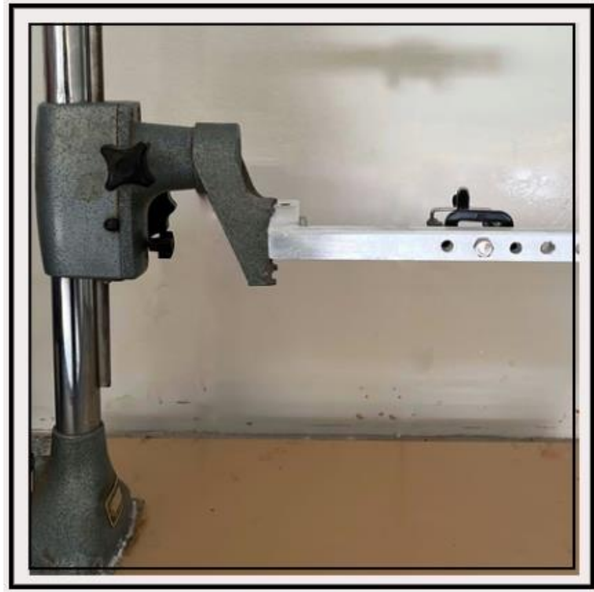
Figura 2 – Suporte de celular para coletar as imagens
