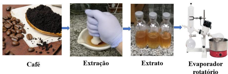
Figura 13. Esquema da extração dos compostos bioativos do café
