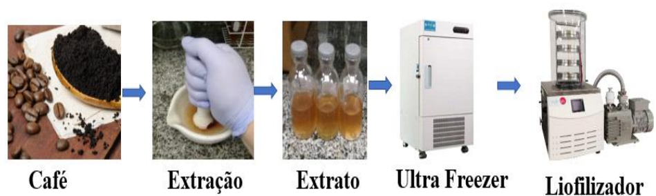
Figura 14. Esquema de extração aquosa
