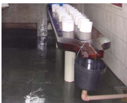
Figura 23 – Sistema de canalização do soro para o seu direcionamento na alimentação animal.
