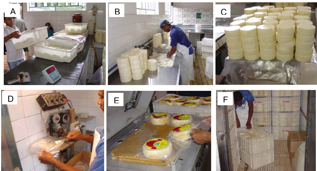
Figura 21 – Tratamento dado ao queijo minas artesanal do Serro antes da sua comercialização: A - Chegada do queijo ao entreposto. B - Limpeza. C - Pesagem. D - Numeração do lote e número do produtor na embalagem. E - Embalagem a vácuo. F - Resfriamento.
