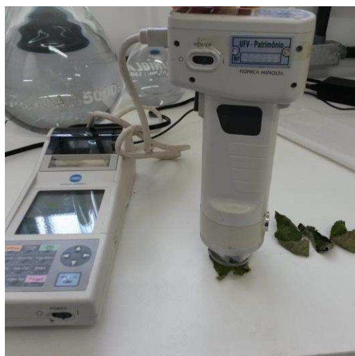
Figura 9 – Colorímetro utilizado para a leitura das coordenadas CIELAB. (FONTE: Naiara Cristina Zotti).
