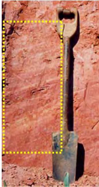
Figura 54 - Perfil de onde foi coletado o solo em estudo. Notar a xistosidade herdada da rocha de origem à esquerda da pá.
