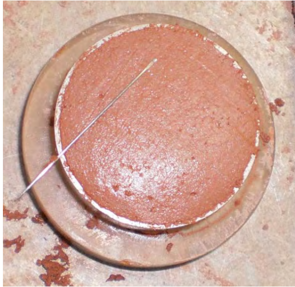
Figura 66 - Solo moldado no anel de adensamento antes do arrasamento de sua face.
