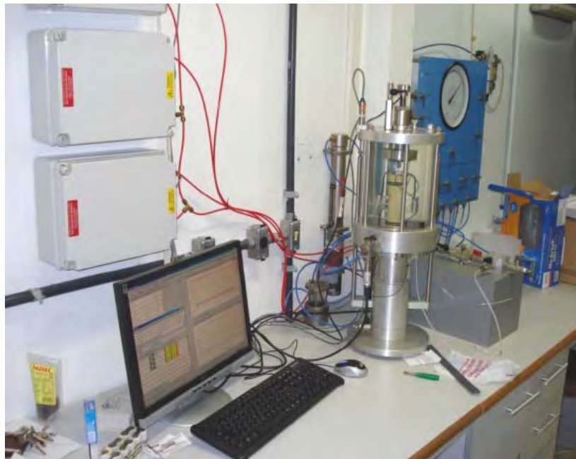
Figura 59 - Equipamento triaxial “Bishop-Wesley” utilizado (PUC-Rio).
