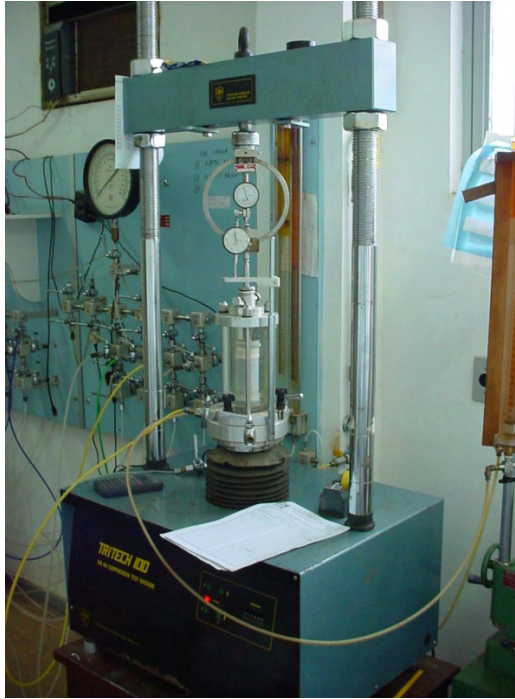
Figura 58- Equipamento triaxial da UFV utilizado no ensaio CA800.
