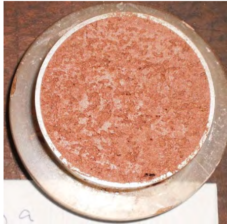
Figura 64 - Amostra estruturada moldada em anel de adensamento.
