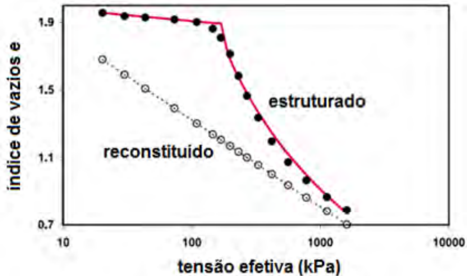
Figura 47 - Comportamento de uma argila no ensaio edométrico (YONG & NAGARAJI, 1977).
