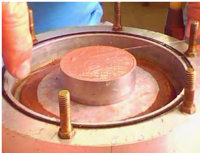
Figura 67 - Arrasamento da face da amostra no anel de adensamento com uso de linha de nylon para w = 1,5.LL .
