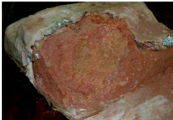
Figura 17 - Plano de fraqueza encontrado em bloco indeformado.
