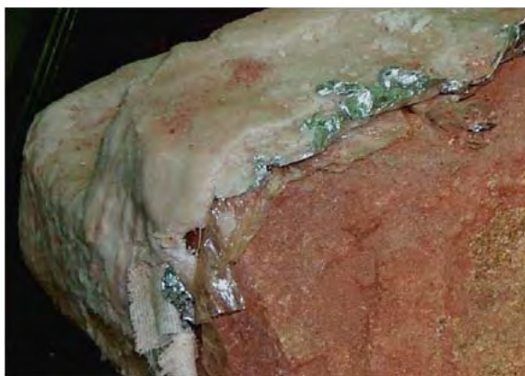
Figura 55 - Camadas de impermeabilização do bloco indeformado.
