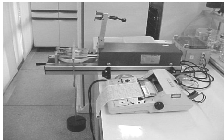
FIGURA 6. Aparelho de cisalhamento de Jenike.
