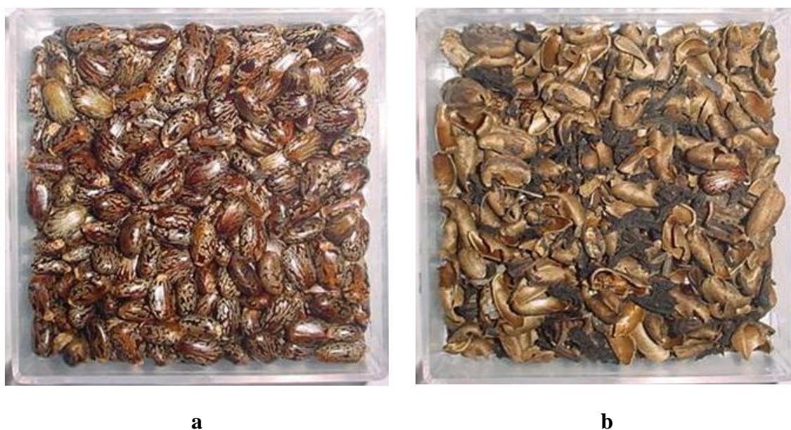
FIGURA 1. Amostras dos grãos de mamona sem impurezas (a) e das impurezas grossas provenientes do processamento dos grãos (b).
