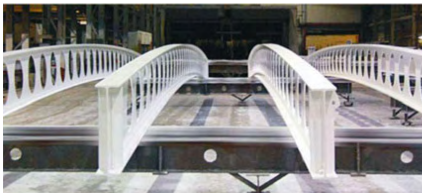
Figura 39 – Viga celular para um sistema de cobertura (fonte: www.arcelormittal.com – acessado em 04/10/11).
