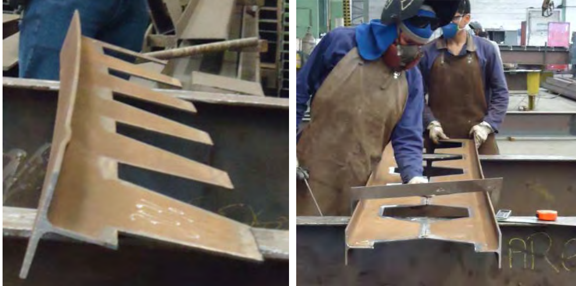
Figura 50 – Empenamento da metade de um perfil I laminado, após o corte, devido às tensões residuais (foto: Washington Vieira).
