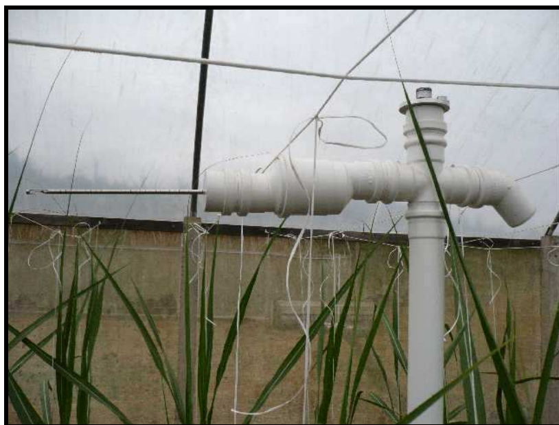
Figura 5 – Vista parcial do tubo de PVC aspirado onde foi instalado internamente o sensor de temperatura e umidade relativa do ar. Na parte externa foram fixados o piranômetro e o anemômetro de fio quente.
