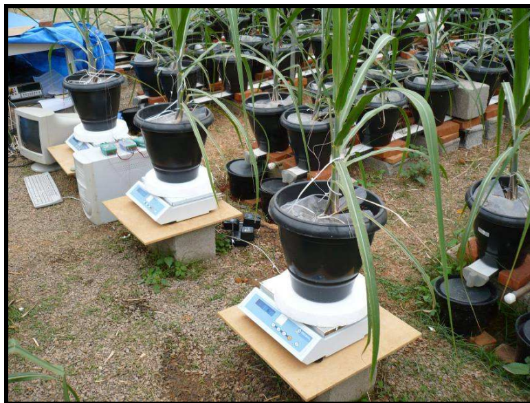
Figura 6 – Sistemas individuais de pesagem para medição da transpiração de plantas de cana-de-açúcar.
