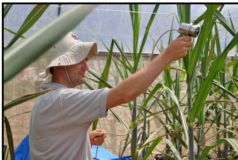
Figura 7 – Medição da temperatura foliar da cana-de-açúcar com um termômetro a infravermelho.
