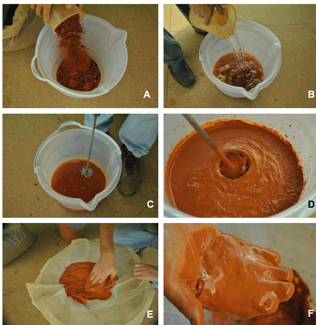
Figura 4.6 – Processo de dispersão mecânica de solo com disco Cowles adaptado para obtenção de pigmentos para produção de tintas. a) e b) Adição de solo e água em recipiente; c) e d) Dispersão com disco Cowles adaptado; e) Peneiramento; f) Aspecto final do material peneirado.
