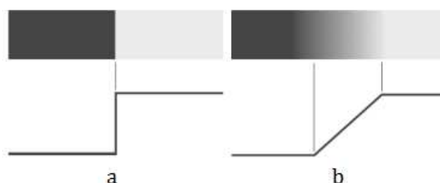
Figura 1 - a) borda degrau ( ideal step edge ), b) borda rampa ( ramp edge ).
