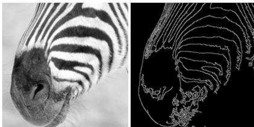
Figura 4 - Bordas detectadas com o Processo de Canny no MATLAB a) imagem original; b) detecção de bordas de Canny.
