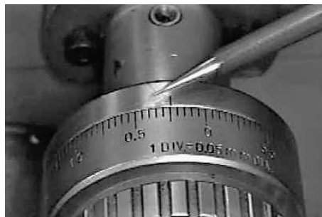
Figura 5.4: Colar Micrométrico de um Torno Mecânico: o colar dessa imagem possui a resolução de 0,05 mm.
