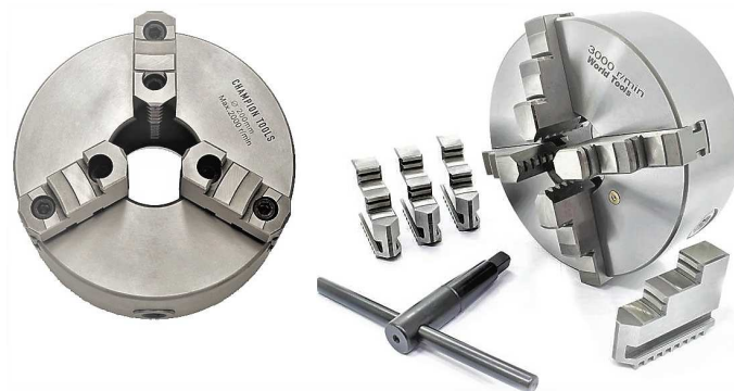
Figura 5.3: Nessa imagem temos a esquerda uma placa com 3 castanhas, a direita uma placa com 4 castanhas, 4 castanhas soltas e uma chave de placa.
