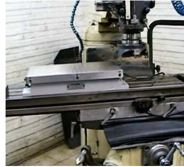
(c) Peça fixada em uma Mesa de Seno Magnética.
