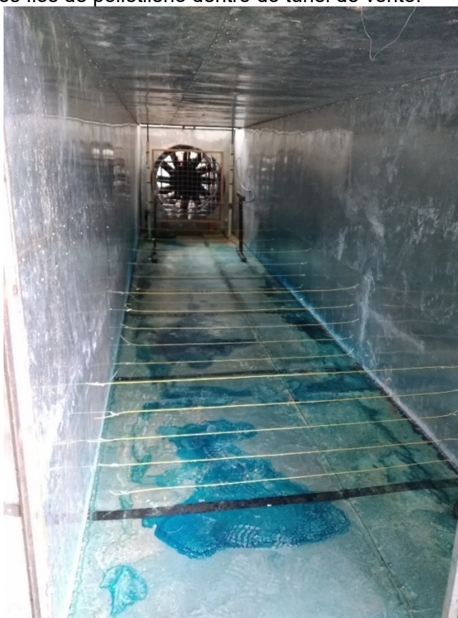
Figura 14 - Disposição dos fios de polietileno dentro do túnel de vento.
