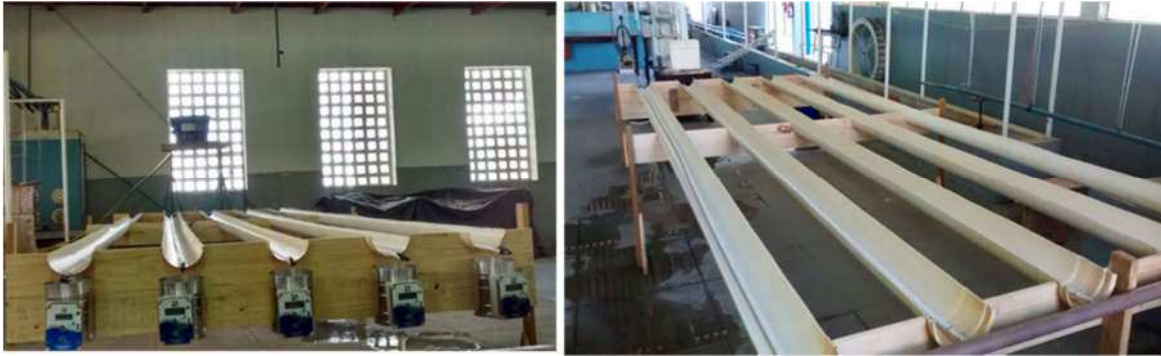
Figura 2 - Estrutura utilizada para ensaios de avaliação do sistema RDI.
