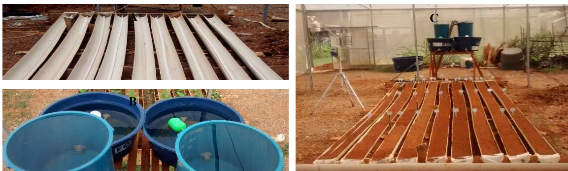
Figura 1. Instalação das fitas porosas RDI (A), sistema de abastecimento de água com boias (B) e preenchimento das calhas com solo (C) Viçosa-MG.
