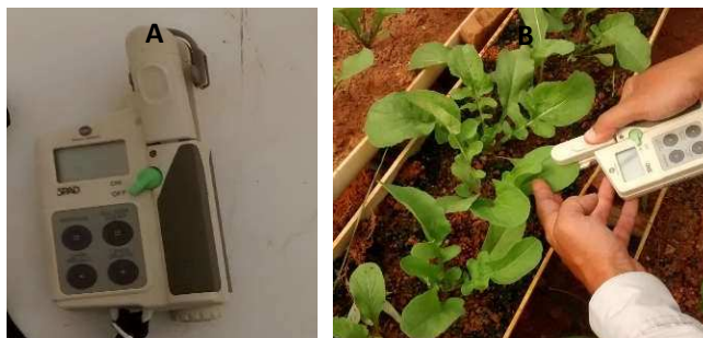
Figura 4: Clorofilômetro portátil SPAD 502 - Minolta (A); Avaliação de clorofila na folha (B)
