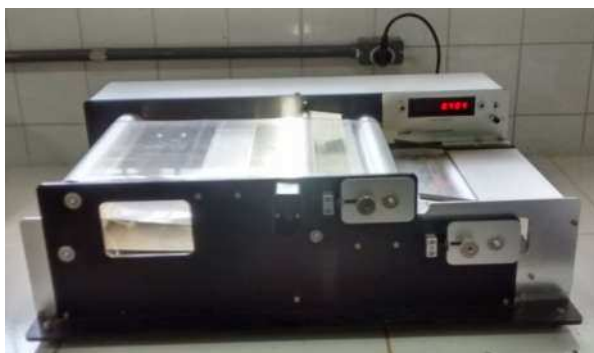
Figura 3: Integrador de área foliar (Licor 3100)
