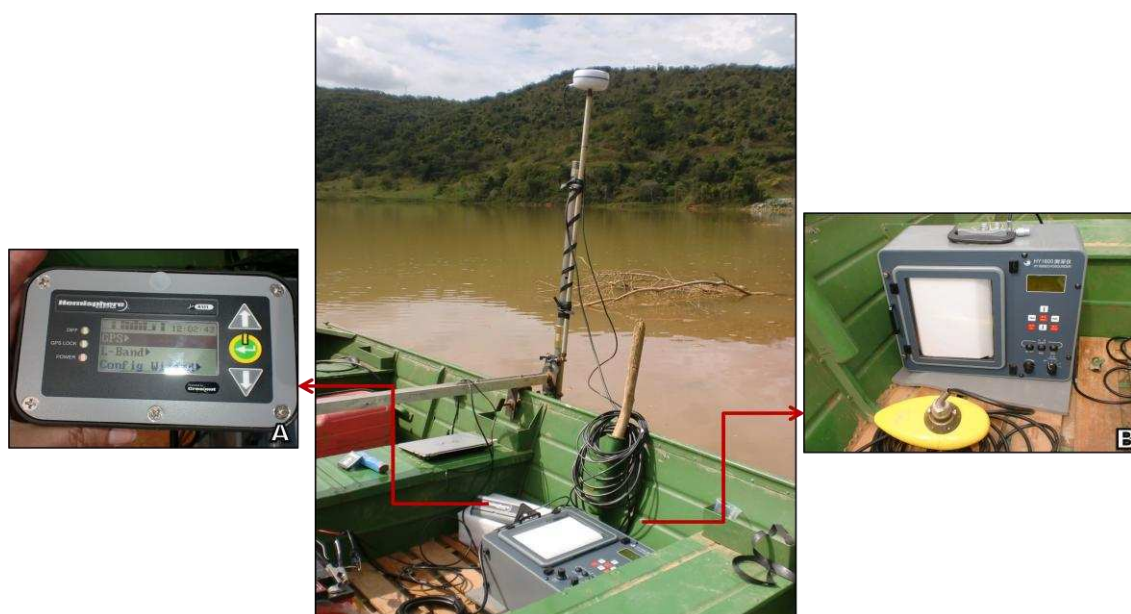
Figura 29 - Esquema do arranjo dos equipamentos utilizados no levantamento batimétrico. A) DGPS e B) ecobatímetro monofeixe.
