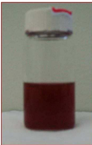
Figura 5. Suspensão coloidal de AuNps formadas pelo copolímero tribloco L64 e \text{HAuCl}_4 \cdot 3\text{H}_2\text{O} .
