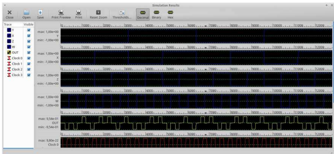
Figura 5.21 – Forma de onda do circuito QCA do Parity Checker .
