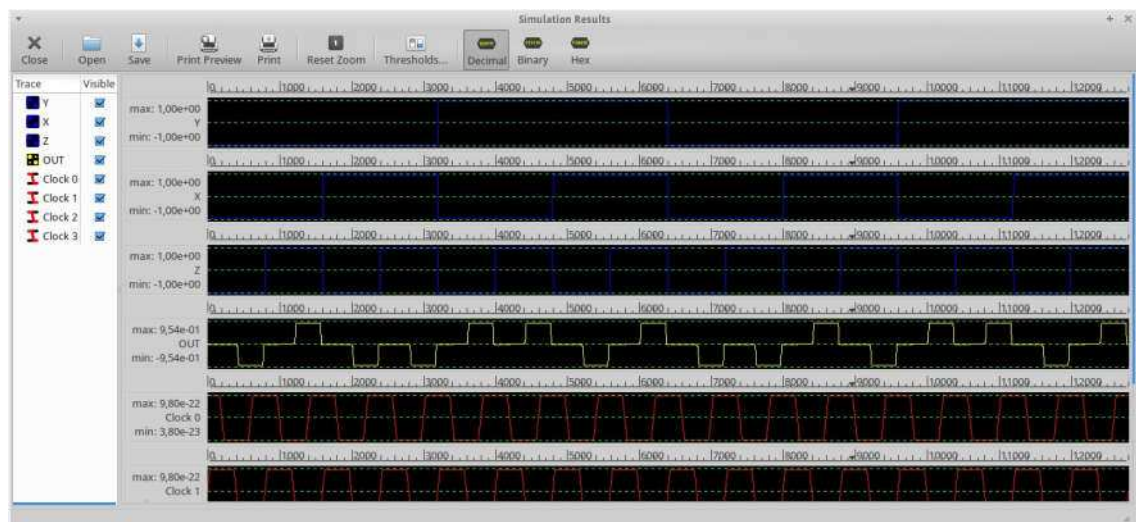
Figura 5.18 – Forma de onda do circuito QCA do Parity Generator .
