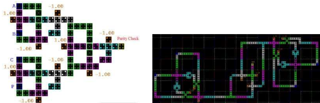
Figura 5.20 – P&R manual do circuito Parity Checker (AHMAD; BHAT, 2012). Resultado do P&R para o Parity Checker no QCADesigner.
