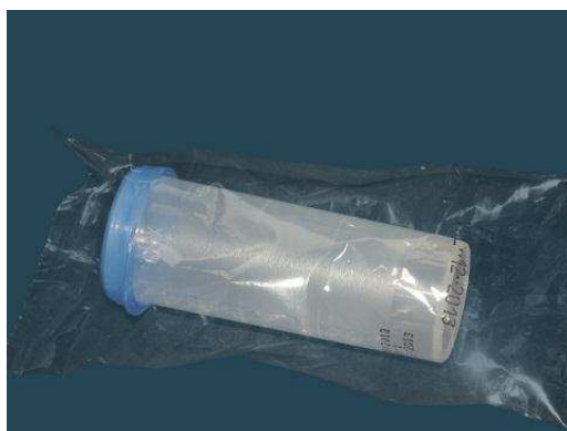
Figura 6 - Frasco plástico esterilizado com um comprimido de Azidiol, usado para coleta de leite destinado a análise de CBT.
