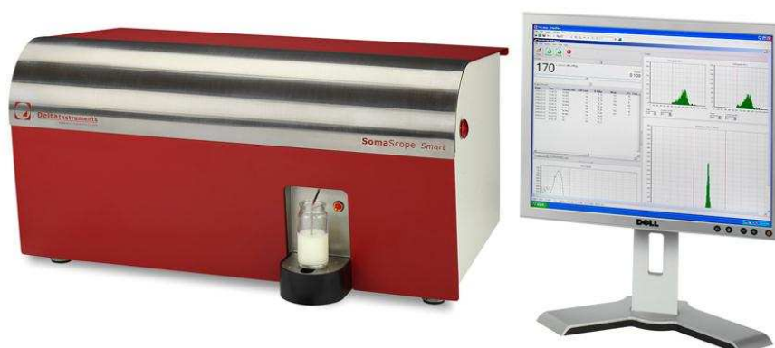
Figura 5 - Equipamento SomaScope, utilizado para contagem de células somáticas e determinação da composição centesimal das amostras de leite
