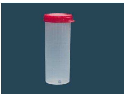
Figura 4 - Frasco plástico com um comprimido de Bronopol®, utilizado para coleta destinada a análise de CCS e composição centesimal.
