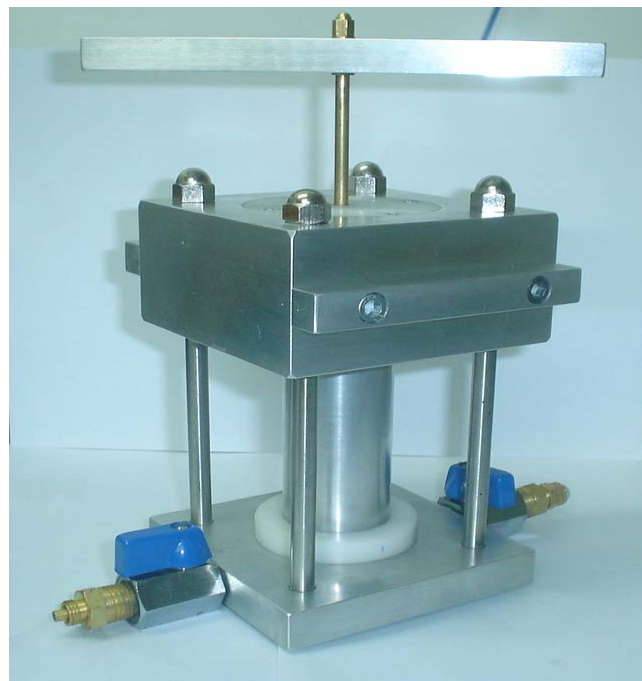
Figura 3.13: Bomba de fluxo finalizada.
