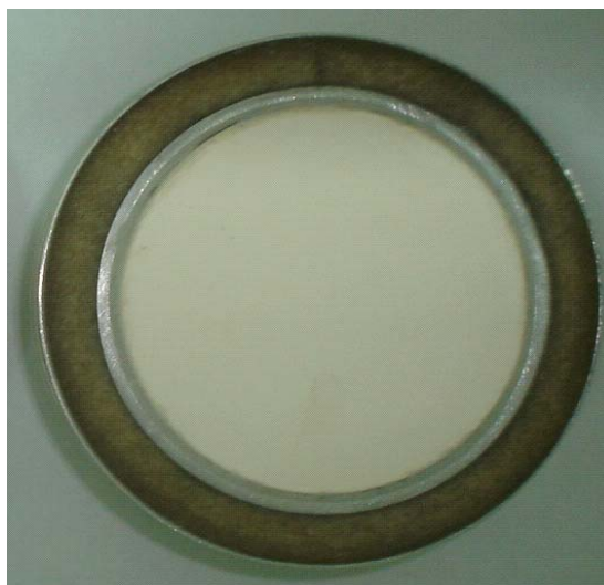
Figura 3.10: Anel e pedra porosa de alta entrada de ar colados no top cap .
