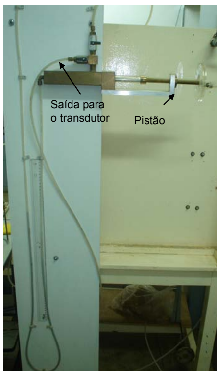
Figura 3.19: Coluna de mercúrio acoplada ao pistão utilizada para calibração do transdutor diferencial de pressão.
