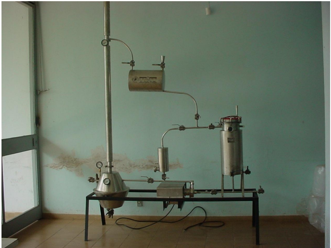
Figura 9 - Sistema de extração por solvente: tanque de extração e destilador.
