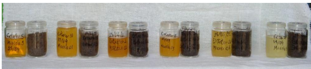
Figura 15 - Micelas e farelos retirados de um grupo de extratores.
