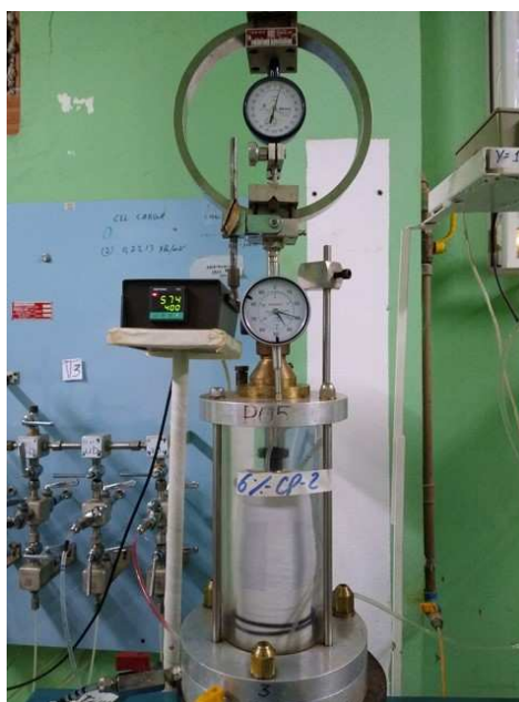
Figura 7: Detalhe da execução de um ensaio de compressão triaxial.
