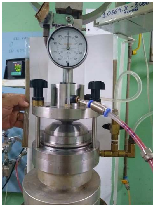
Figura 11: Detalhe da célula CRS após colocação na prensa e preparativos para a execução do ensaio.
