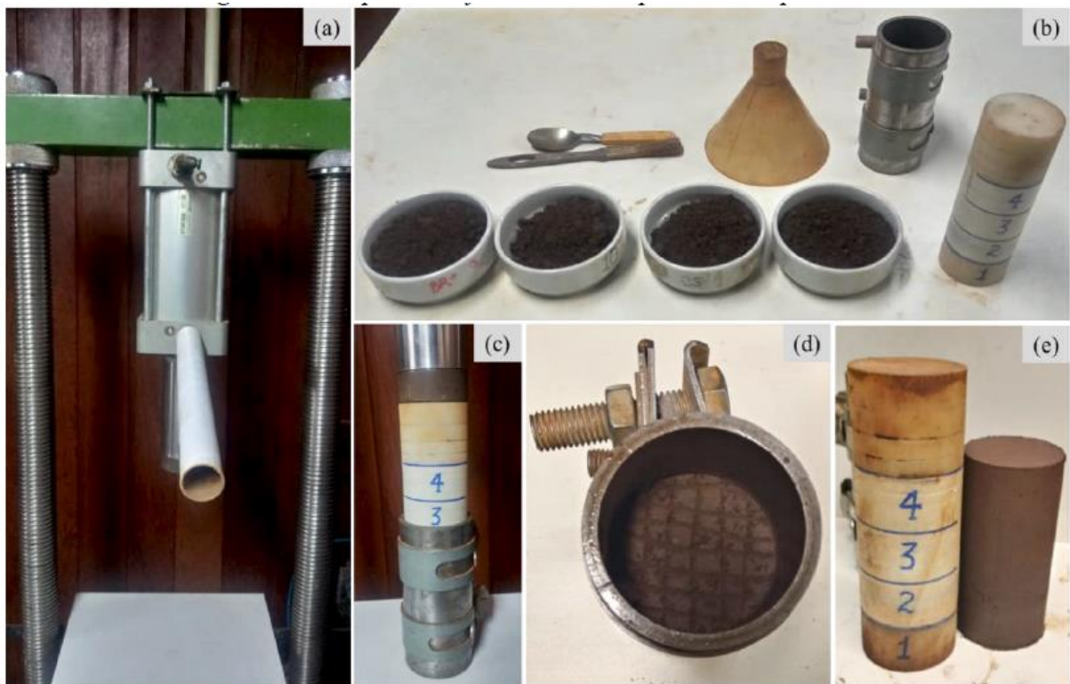
(a) Prensa utilizada para compactação das amostras; (b) equipamentos e materiais utilizados (c) corpo de prova sendo compactado; (d) Escarificação de camada após compactação; (e) Corpo de prova finalizado. Fonte: Adaptado de Carneiro J. (2021).
