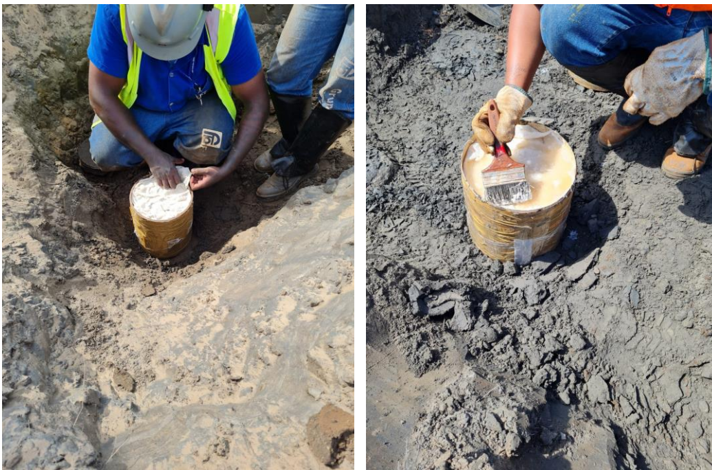
Figura 4.4 – (a) Utilização de talagarça do topo da amostra; (b) Selagem do topo da amostras com parafina.
