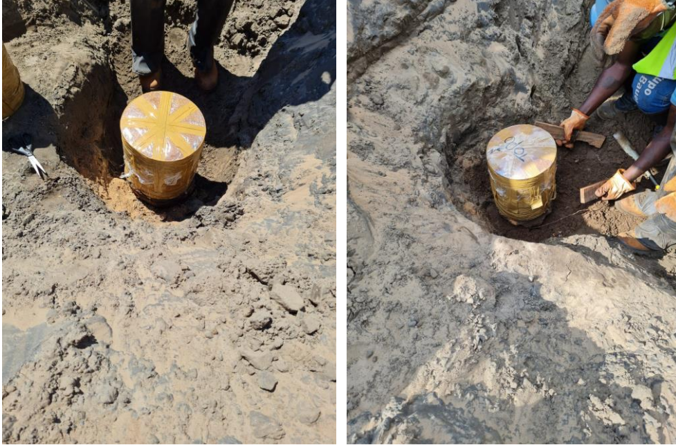
Figura 4.5 – (a) Proteção do topo da amostra com plástico e filme; (b) Separação da base da amostra com fio de aço.
