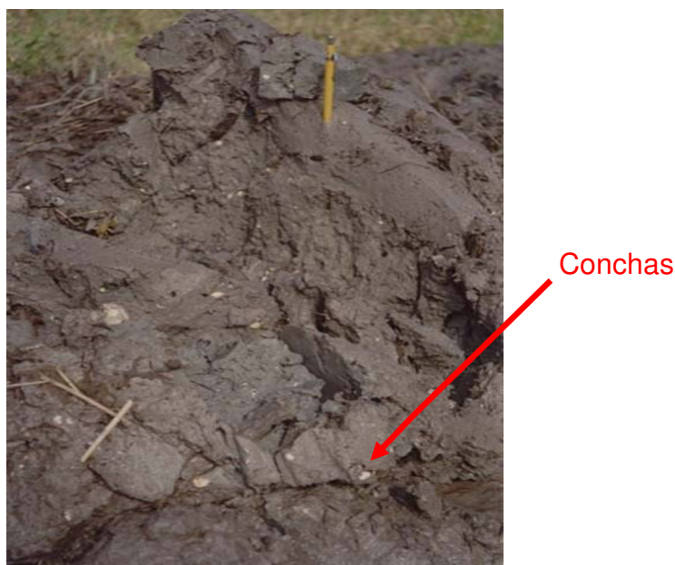
Figura 21. Presença de conchas marinhas no horizonte C (gleizado) observadas durante a retirada por retroscavadeira na limpeza de canal de drenagem em Anchieta.
