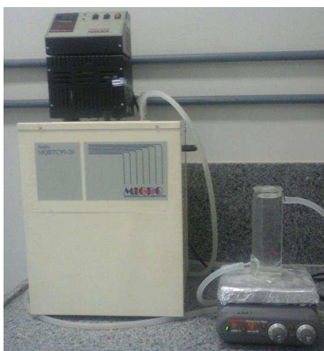
Figura 7: Banho termocriostático utilizado nos experimentos para controle de temperatura.
