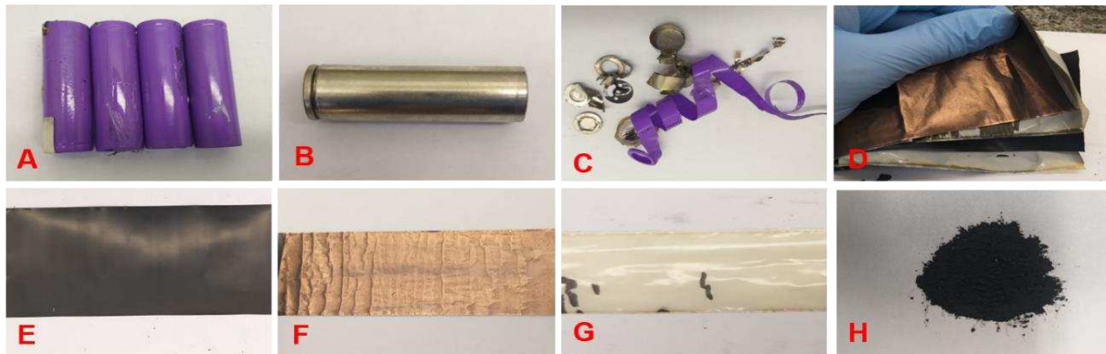
Figura 6: Componentes principais de uma bateria íon-Li desmontada: a - bateria de íon-Li; b - invólucro metálico; c - invólucro polimérico e conectores; d - organização das folhas nas baterias; e - cátodo; f - ânodo; g - separador polimérico e h - pó de bateria íon-Li.
