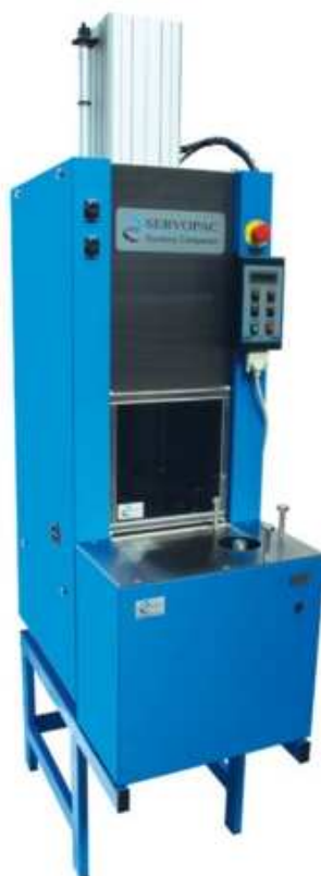
Figura 3.4 - Compactador giratório Superpave IPC Fonte: IPC global, (2016)
