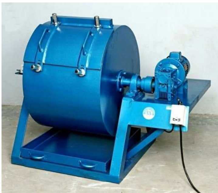
Figura 2.11 – Ilustração da máquina “Los Angeles” Fonte: Justytest, (2016)
