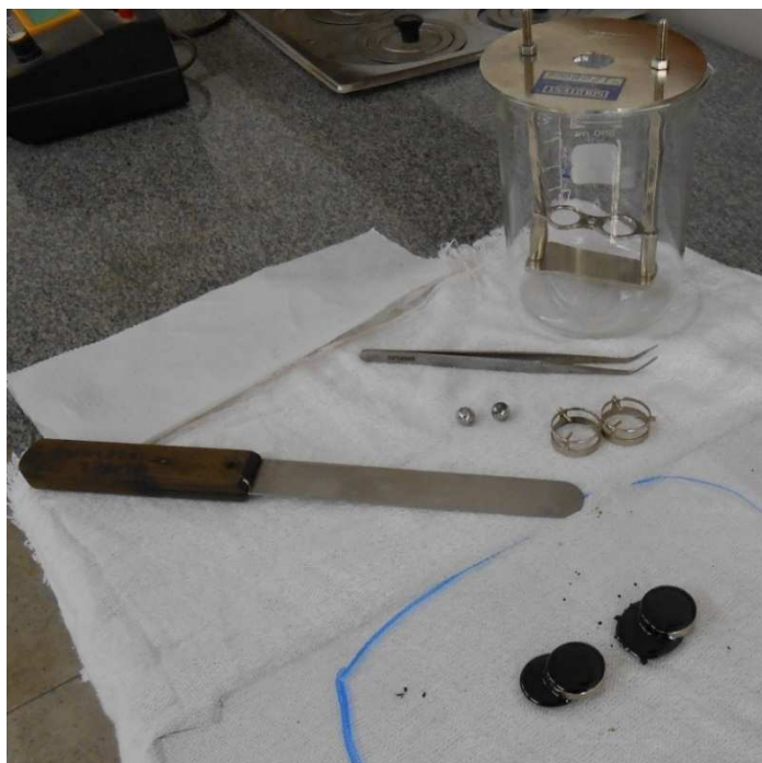
Figura 2.5 - Aparelhagem utilizada no ensaio de Ponto de Amolecimento em amostras de CAP
