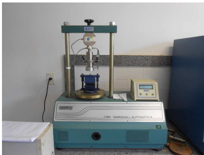
Figura 2.16 - Prensa automática Marshall do Laboratório de pavimentos da UFV
