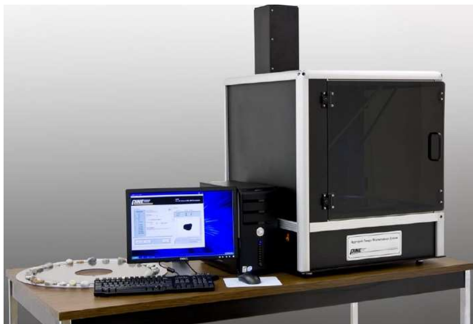
Figura 2.10 – Equipamento para a realização do ensaio Aggregate Image Measurement System (AIMS) Fonte: Operation Manual AIMS, (2011)
