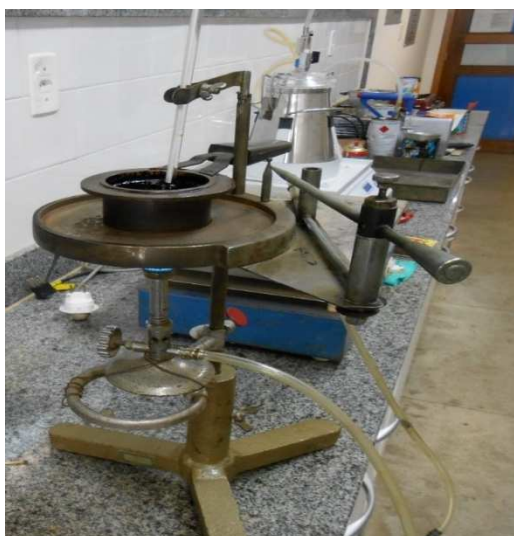
Figura 2.4 - Aparelho para a determinação de ponto de fulgor em amostras de CAP
