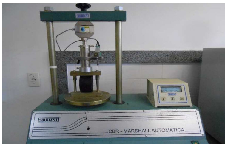
Figura 2.18 - Prensa mecânica utilizada para realização dos ensaios de resistência à tração; Laboratório de asfaltos da UFV Fonte: Autor
