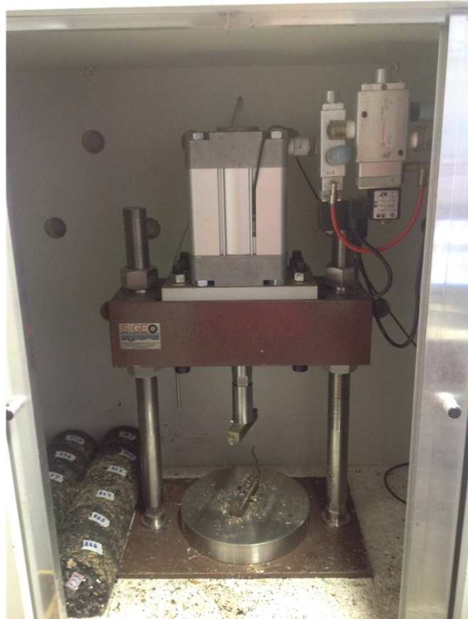
Figura 1 – Equipamento utilizado nos ensaios de módulo de resiliência e vida de fadiga
