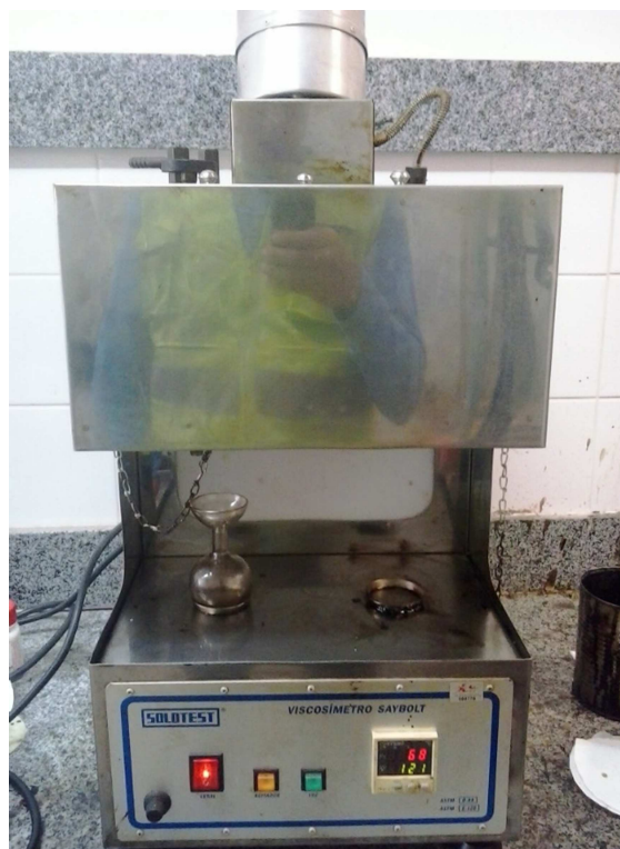
Figura 2.3 - Equipamento para realizar o ensaio de viscosidade Fonte: Autor
