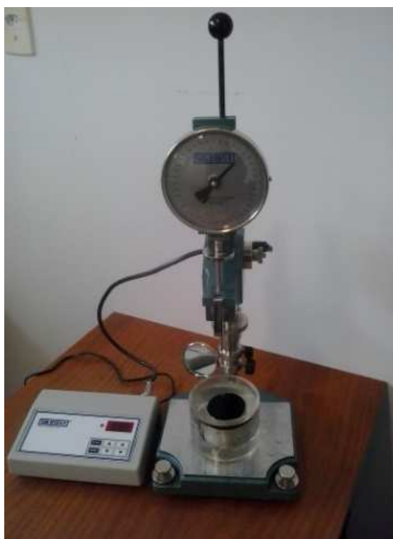
Figura 2.2 - Equipamento para realização do ensaio de penetração Fonte: Autor
