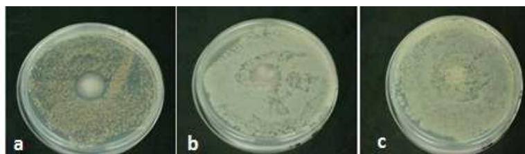
Figura 3. Atividade antimicrobiana “ in vitro ” (pela formação de halo de inibição) dos filmes incorporados com nanoemulsão de óleo essencial de carqueja sobre S. aureus (a) P. aeruginosa (b) e E. coli (c).
