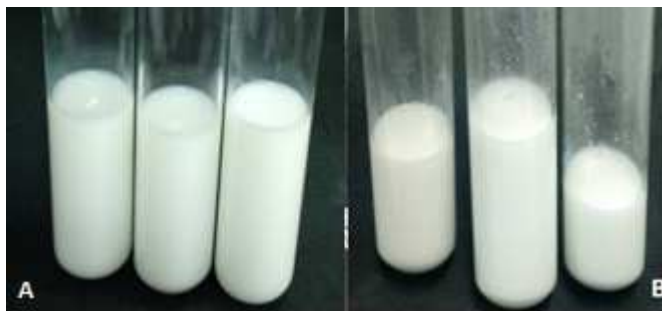
Figura 2. Nanoemulsão de óleo essencial de carqueja antes do estresse térmico (A) e após o estresse térmico (B).
