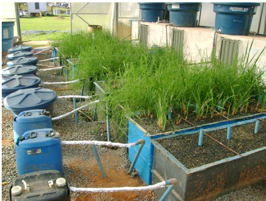
Figura 1.7. Sistema de coleta e armazenamento dos efluentes dos SACs.
