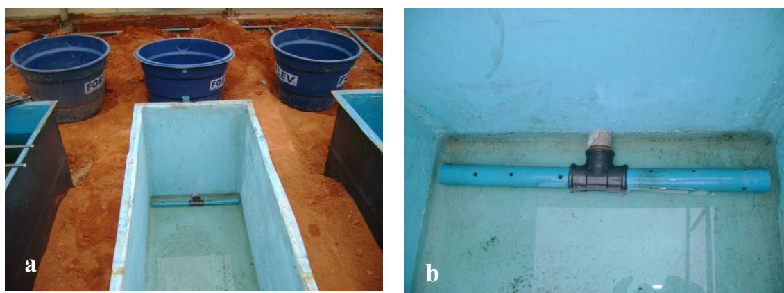
Figura 1.3. Sistema de drenagem implantado na área experimental (a) e detalhe do sistema de drenagem implantado nos SACs (b).
