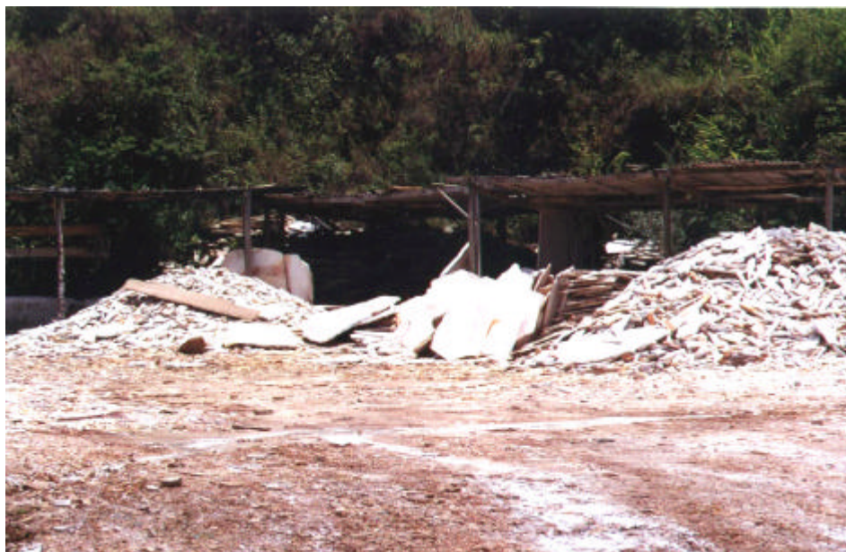
Figura 8: Pilhas de rejeitos e material beneficiado sem separação (Ponto amostral 5 – Saída para Mariana).
