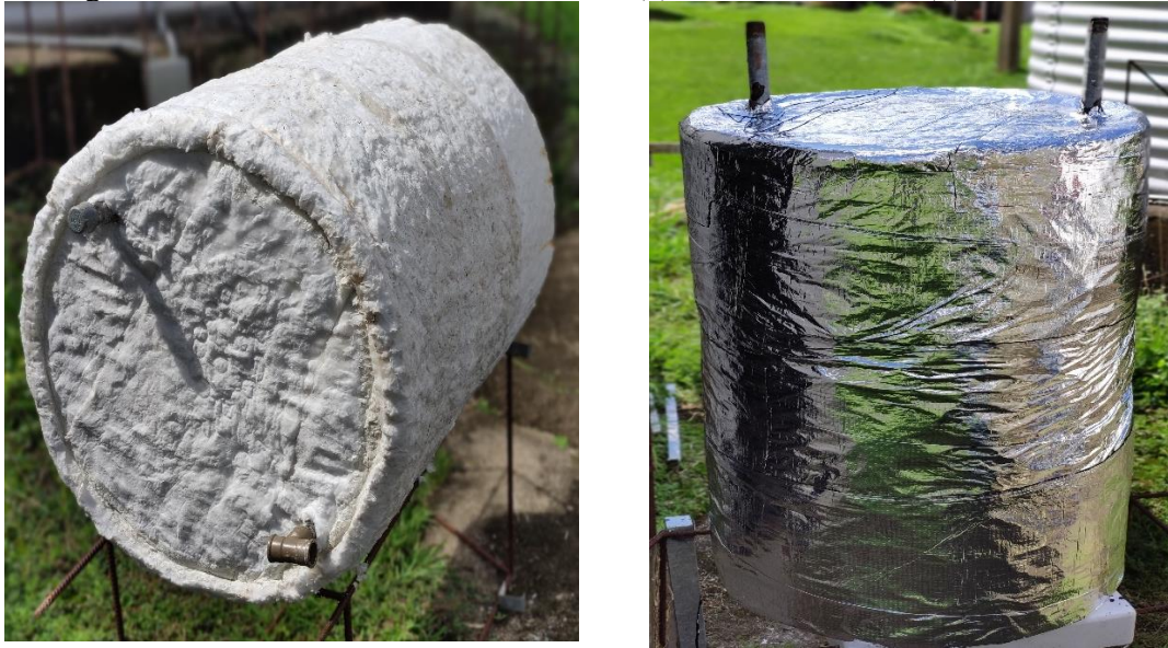
Figura 5 - Revestimento do reservatório: (a) Manta cerâmica; (b) Manta asfáltica.
