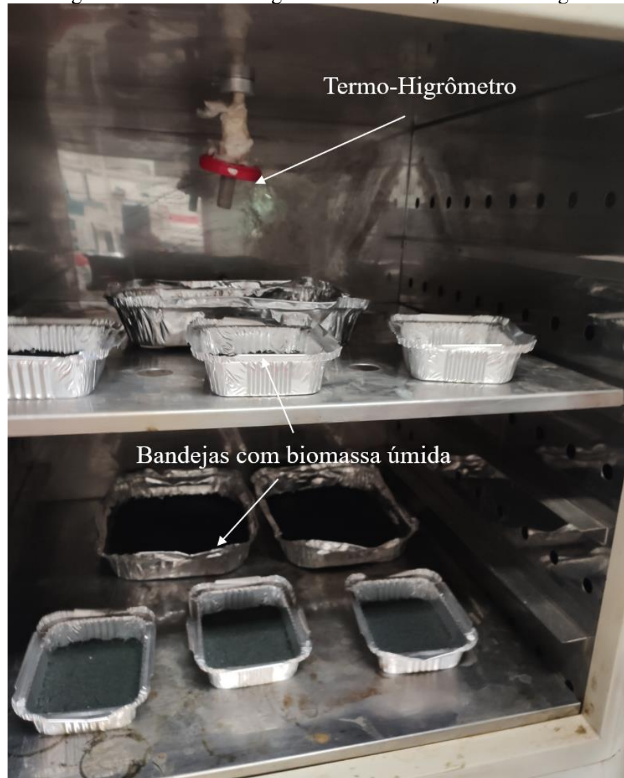
Figura 4 - Estufa de secagem com as bandejas de microalgas
