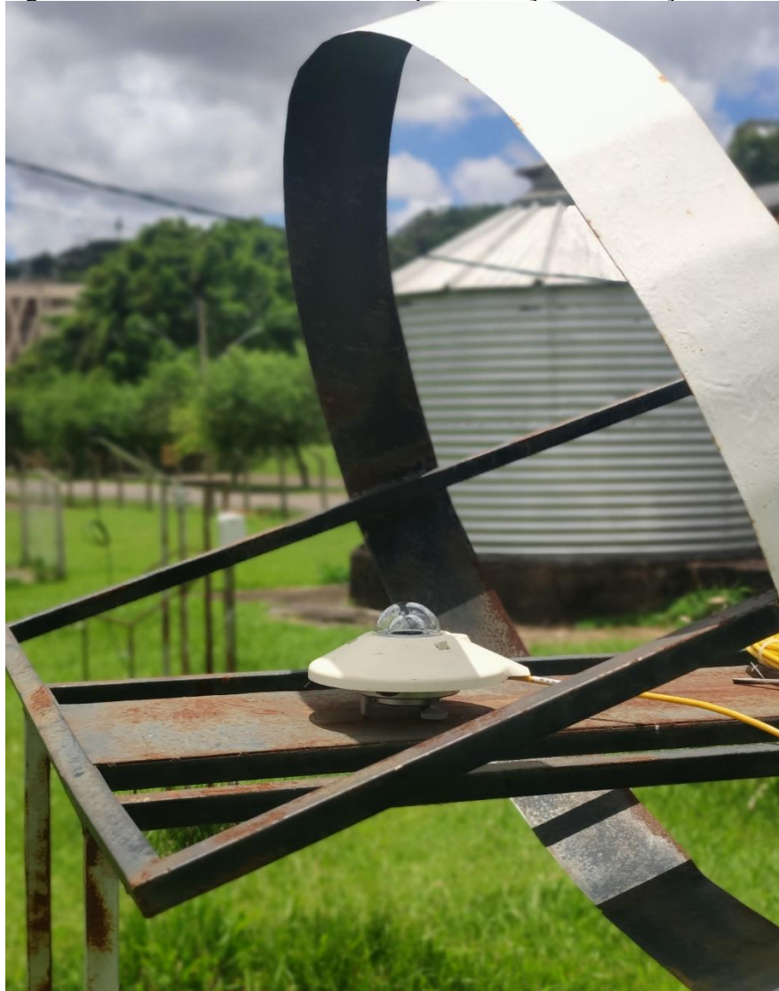
Figura 11 - Piranômetro sombreado para medição da radiação difusa.
