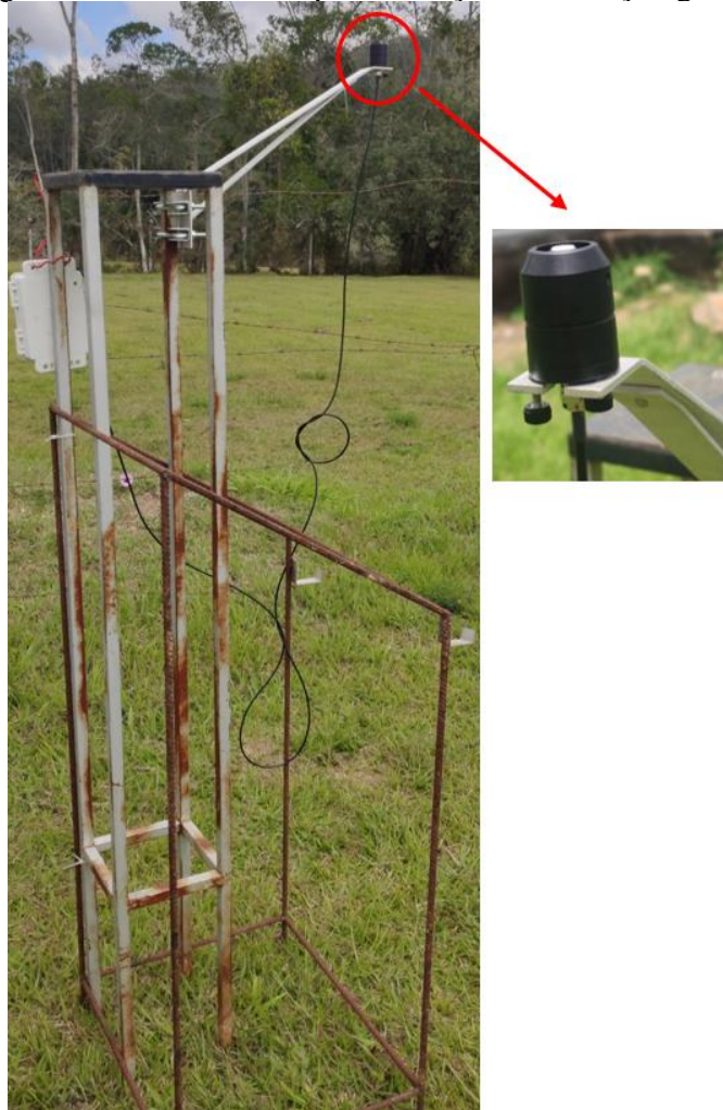
Figura 10 - Piranômetro para medição da radiação global.
