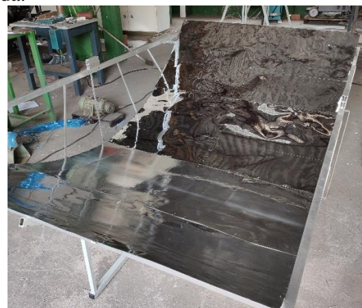
Figura 4 – Superfície da calha (coletor): (a) chapas de alumínio liso, e (b) película reflexiva instalada.
