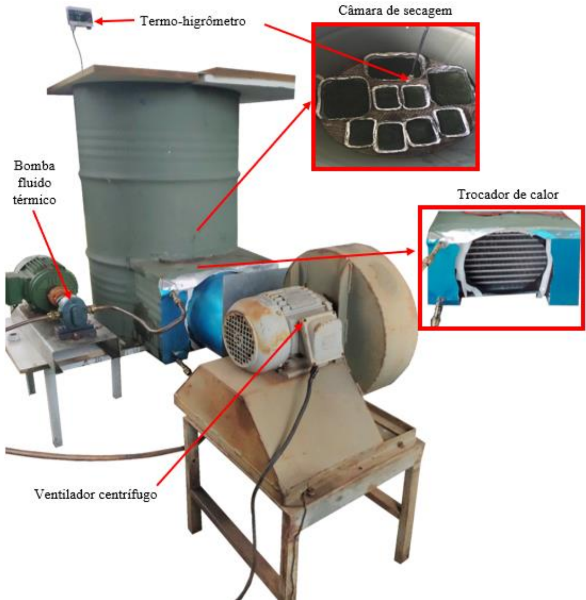
Figura 3 - Secador construído
