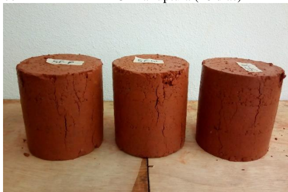
FIGURA B.23 – 4º lote de corpos de prova de 5% de licor-cimento CP II-F-32 na ruptura (28 dias)
