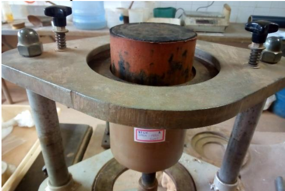
FIGURA 30 – Topo de corpo de prova com 3% de licor negro kraft (3% – A) parcialmente desmoldado e acúmulo de componentes do licor em suas faces
