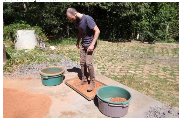
FIGURA 10 – Destorroamento do solo com os pés sobre bandeja metálica
