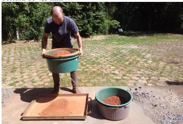
FIGURA 9 – Peneiramento do solo na peneira com abertura de 4,8 mm
