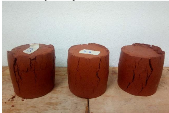
FIGURA B.4 – 1º lote de corpos de prova da mistura 3% de licor negro na ruptura (7 dias)
