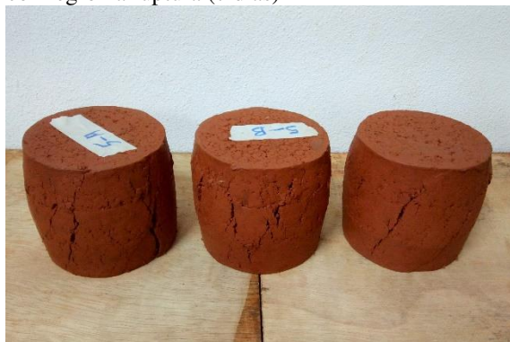
FIGURA B.14 – 1º lote de corpos de prova de 5% de licor negro na ruptura (7 dias)
