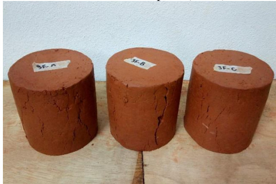
FIGURA B.10 – 1º lote de corpos de prova de 3% de licor-cimento CP II-F-32 na ruptura (7 dias)
