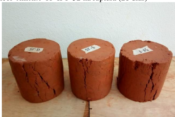
FIGURA B.21 – 2º lote de corpos de prova de 5% de licor-cimento CP II-F-32 na ruptura (28 dias)
