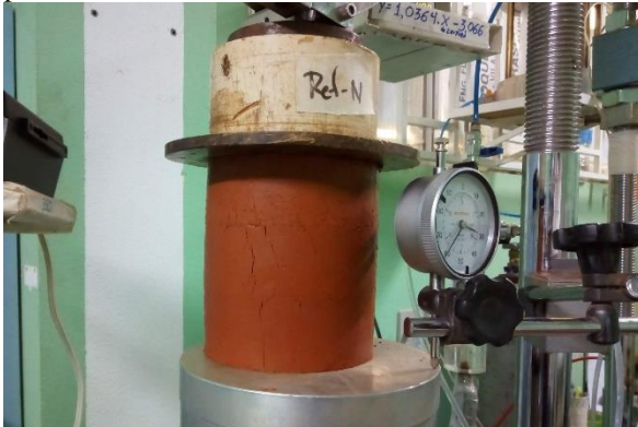
FIGURA 40 – Início da fissuração no solo natural: presença de fissuras no centro e extremidades do corpo de prova
