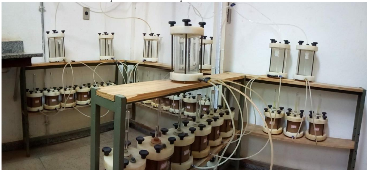
FIGURA 25 – Vista frontal do sistema de percolação em coluna implementado por Caneschi (2012) em uso, com a realização simultânea de 21 permeâmetros e sete células de interface
