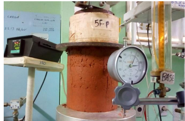
FIGURA 49 – Avanço da fissuração na mistura com 5% de licor-cimento CP II-F-32: encontro das fissuras do centro com as das extremidades
