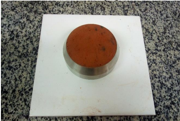
FIGURA 32 – Topo do anel com corpo de prova talhado (3% – A): face menos impregnada
