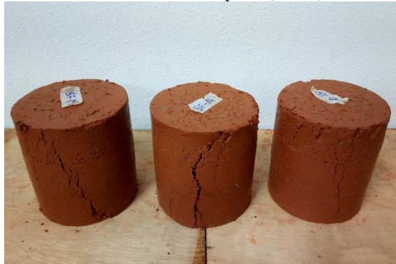
FIGURA B.22 – 3º lote de corpos de prova de 5% de licor-cimento CP II-F-32 na ruptura (7 dias)
