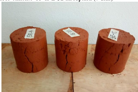
FIGURA B.18 – 1º lote de corpos de prova de 5% de licor-cimento CP II-E-32 na ruptura (7 dias)
