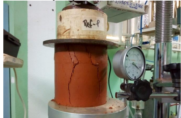
FIGURA 41 – Avanço da fissuração no solo natural: comunicação das fissuras do centro com as das extremidades do corpo de prova
