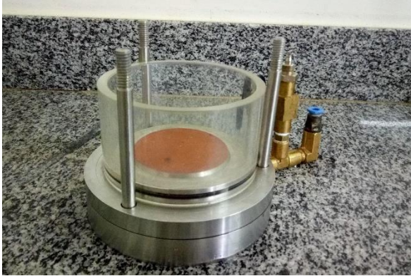
FIGURA 36 – Câmara de pressão com corpos de prova inseridos sobre a base da célula
