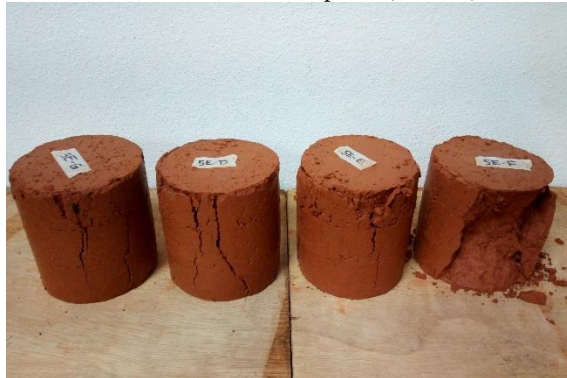
FIGURA B.19 – 2º lote de corpos de prova de 5% de licor-cimento CP II-E-32 na ruptura (28 dias)
