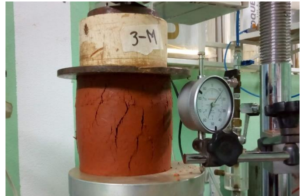
FIGURA 43 – Avanço da fissuração na mistura com 3% de licor: abertura das fissuras centrais e avanço para as extremidades
