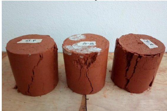
FIGURA B.13 – 4º lote de corpos de prova de 3% de licor-cimento CP II-F-32 na ruptura (28 dias)
