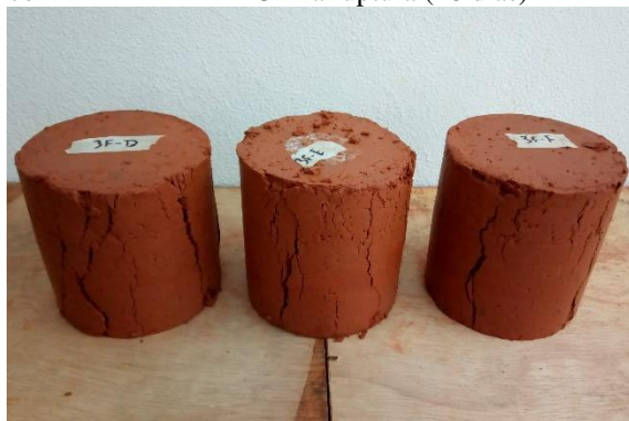
FIGURA B.11 – 2º lote de corpos de prova de 3% de licor-cimento CP II-F-32 na ruptura (28 dias)
