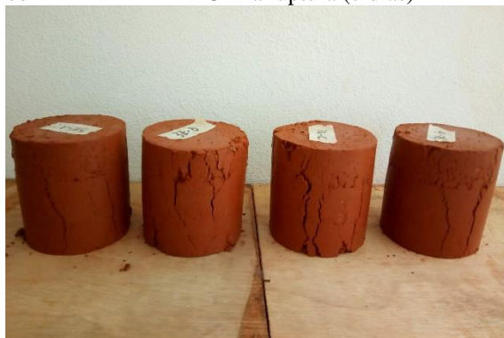
FIGURA B.8 – 1º lote de corpos de prova de 3% de licor-cimento CP II-E-32 na ruptura (7 dias)
