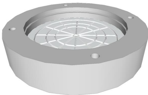
FIGURA 16 – Esquematização: sistemas radial e concêntrico de ranhuras na base
