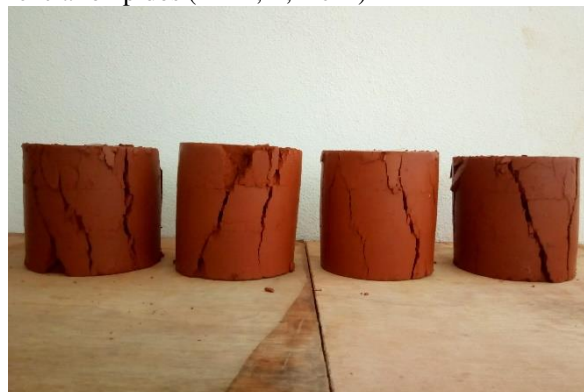
FIGURA 29 – Segundo lote de corpos de prova referência rompidos (R - D, E, F e H)
