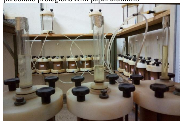
FIGURA 24 – Permeômetros com tubos para coleta do percolado protegidos com papel alumínio
