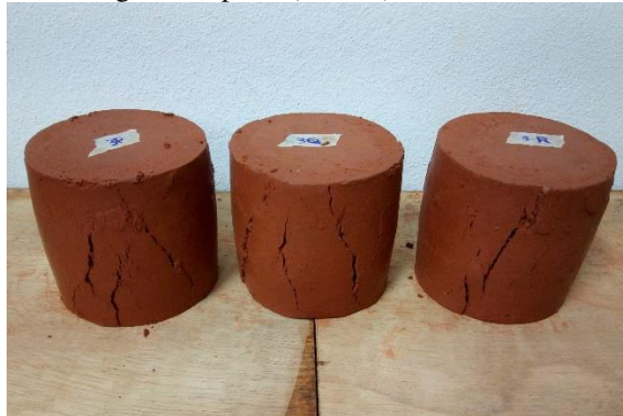
FIGURA B.7 – 4º lote de corpos de prova da mistura 3% de licor negro na ruptura (28 dias)
