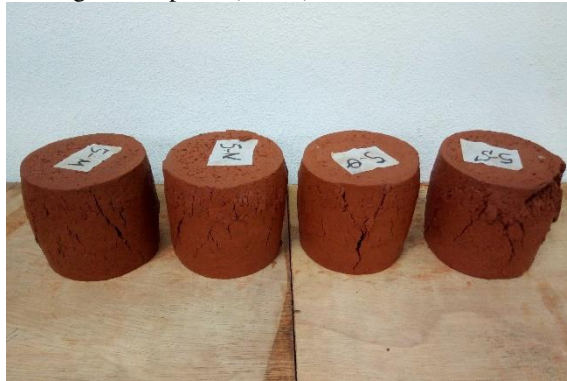
FIGURA B.16 – 3º lote de corpos de prova de 5% de licor negro na ruptura (7 dias)
