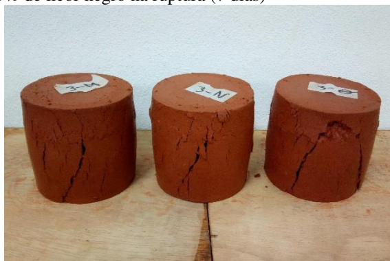
FIGURA B.6 – 3º lote de corpos de prova da mistura 3% de licor negro na ruptura (7 dias)
