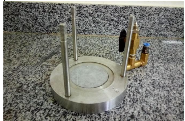
FIGURA 35 – Base da célula de adensamento CRS preenchida com água destilada e com a papel filtro e pedra porosa encaixados
