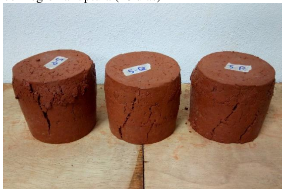
FIGURA B.17 – 4º lote de corpos de prova de 5% de licor negro na ruptura (28 dias)
