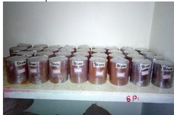
FIGURA 27 – Corpos de prova dos ensaios de compressão simples armazenados na câmara úmida aguardando os tempos de cura
