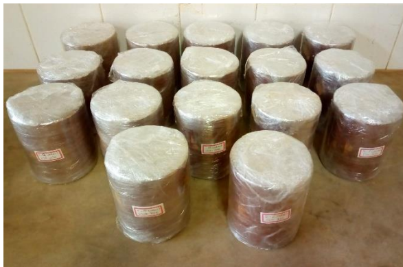
FIGURA 26 – Corpos de prova dos ensaios de compressão simples recém moldados, embalados com filme PVC e identificados
