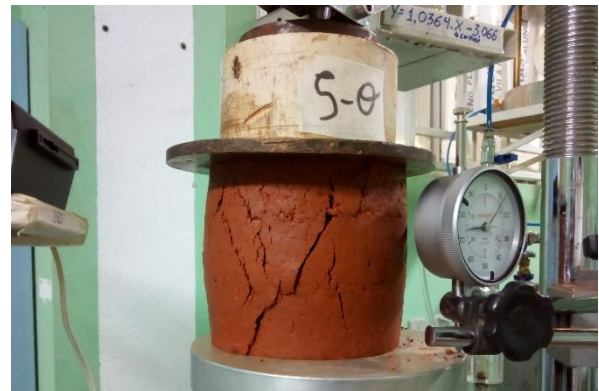
FIGURA 45 – Avanço da fissuração na mistura com 5% de licor: abertura das fissuras centrais e avanço para as extremidades
