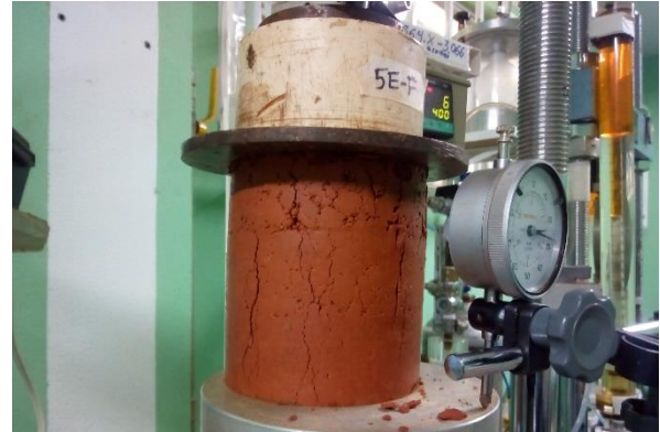
FIGURA 47 – Avanço da fissuração na mistura com 5% de licor-cimento CP II-E-32: encontro das fissuras do centro com as das extremidades
