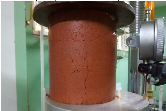
FIGURA 48 – Início da fissuração na mistura com 3% de licor-cimento CP II-F-32: presença de fissuras na base do corpo de prova e iniciando na parte central
