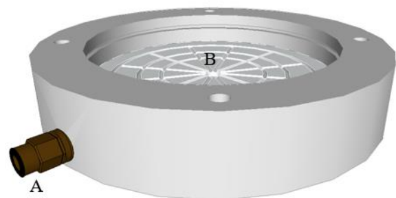
FIGURA 17 – Esquematização: ponto de entrada e saída de fluido percolante na base
