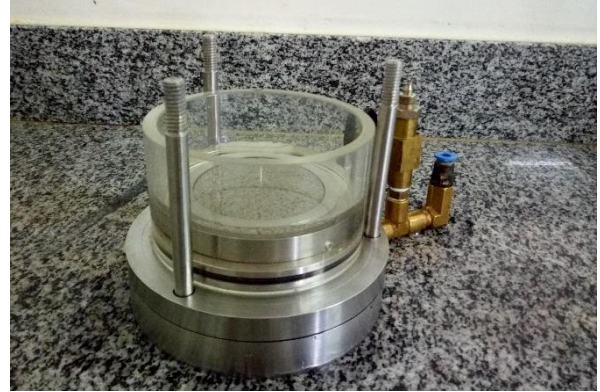
FIGURA 37 – Colar guia apoiado sobre borda biselada do anel e pedra porosa sobre corpo de prova
