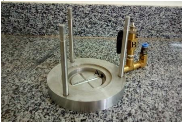
FIGURA 34 – Base da célula de adensamento CRS, evidenciando ponto de saída (A), registro (B) e conector (C)
