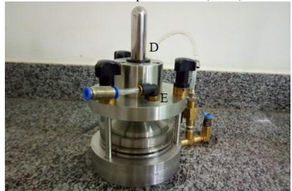
FIGURA 39 – Célula de adensamento CRS montada, evidenciando conectores pneumáticos (D e E)
