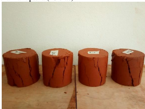
FIGURA B.2 – 2º lote de corpos de prova do solo natural na ruptura (28 dias)
