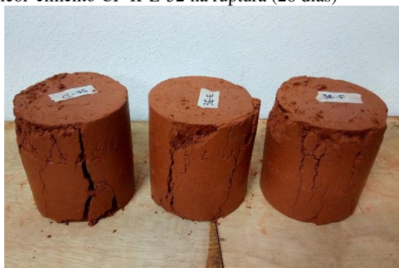
FIGURA B.9 – 2º lote de corpos de prova de 3% de licor-cimento CP II-E-32 na ruptura (28 dias)
