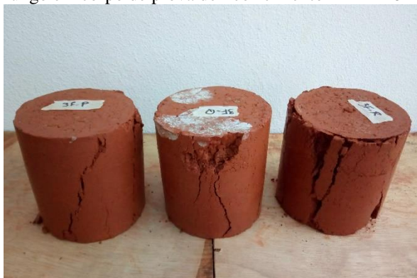
FIGURA 50 – Desenvolvimento predominante de fungo em corpo de prova de licor-cimento CP II-F-32
