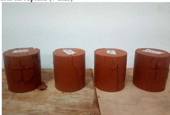
FIGURA B.1 – 1º lote de corpos de prova do solo natural na ruptura (7 dias)
