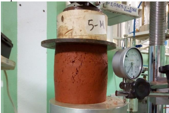
FIGURA 44 – Início da fissuração na mistura com 5% de licor: presença de fissuras apenas no centro do corpo de prova
