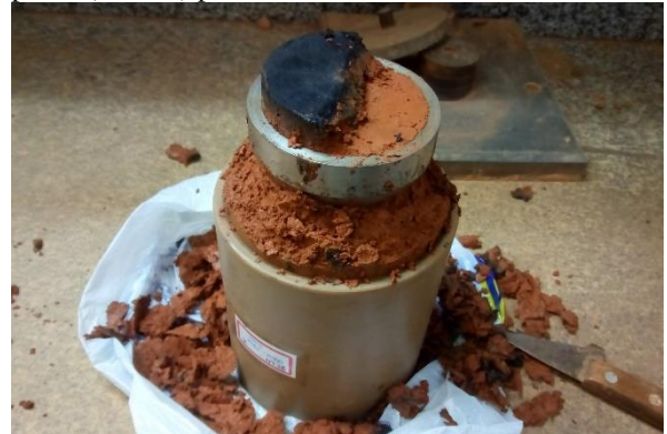
FIGURA 31 – Parte impregnada por componentes do licor sendo eliminada durante talhagem de corpo de prova (3% - C) para ensaio de adensamento CRS
