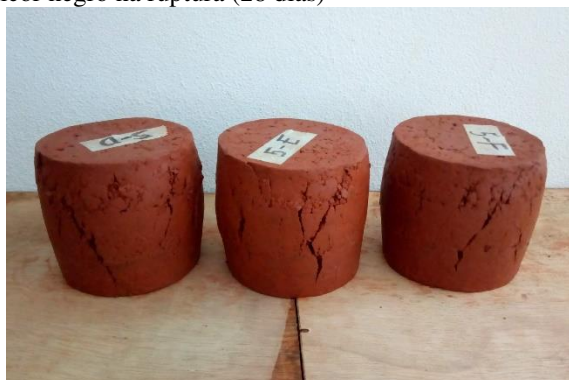
FIGURA B.15 – 2º lote de corpos de prova de 5% de licor negro na ruptura (28 dias)
