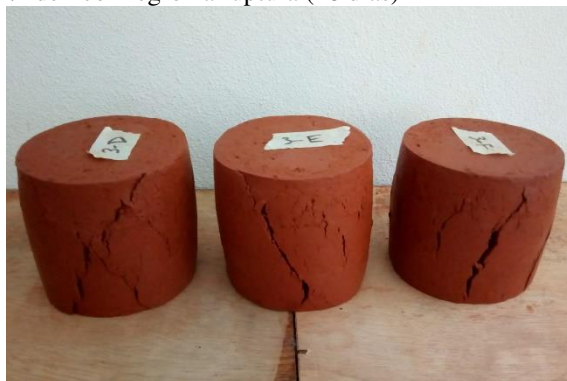
FIGURA B.5 – 2º lote de corpos de prova da mistura 3% de licor negro na ruptura (28 dias)
