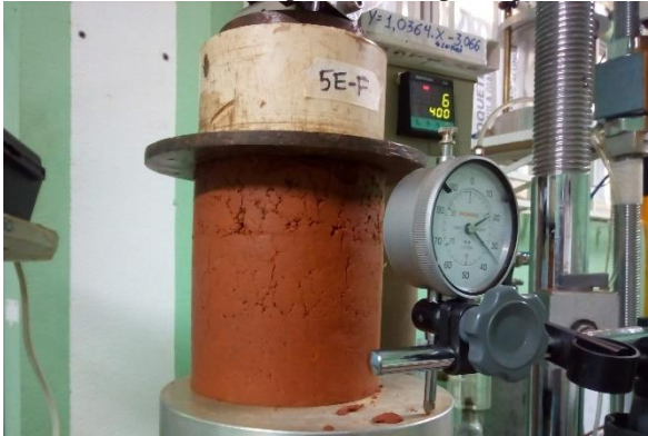
FIGURA 46 – Início da fissuração na mistura com 5% de licor-cimento CP II-E-32: presença de fissuras no centro e extremidade superior do corpo de prova
