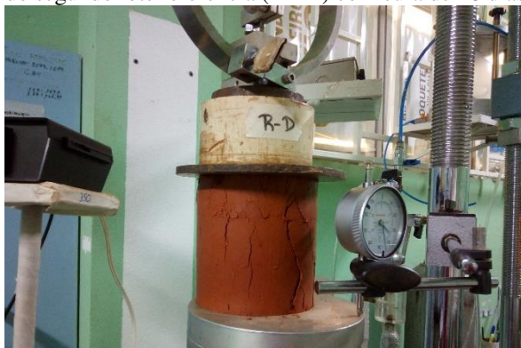
FIGURA 28 – Rompimento do quarto corpo de prova do segundo lote referência (R - D) com cura de 28 dias
