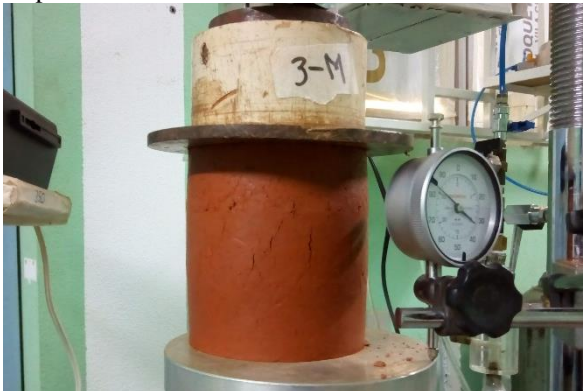
FIGURA 42 – Início da fissuração na mistura com 3% de licor: presença de fissuras apenas no centro do corpo de prova
