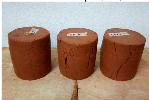
FIGURA B.20 – 1º lote de corpos de prova de 5% de licor-cimento CP II-F-32 na ruptura (7 dias)
