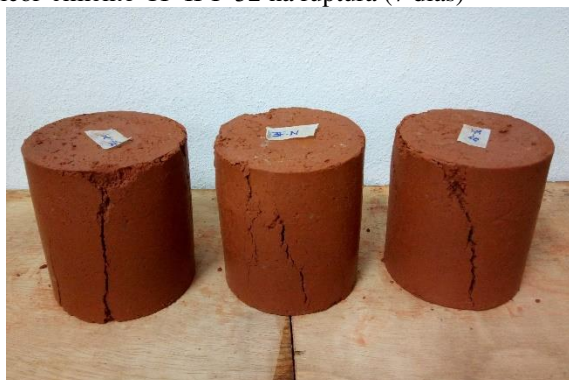
FIGURA B.12 – 3º lote de corpos de prova de 3% de licor-cimento CP II-F-32 na ruptura (7 dias)
