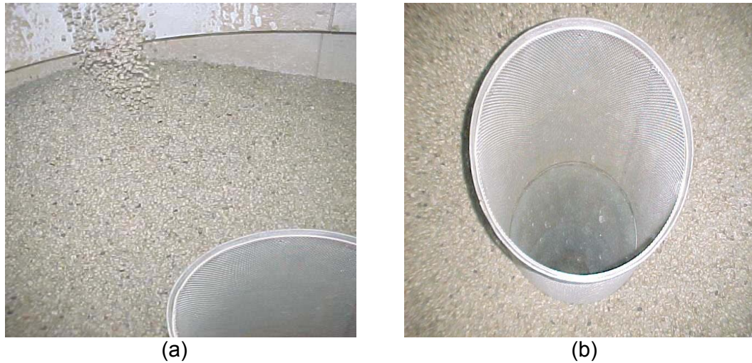
FIGURA 8 - (a, b) Vista da compactação natural dos grãos de café durante o carregamento do silo.
