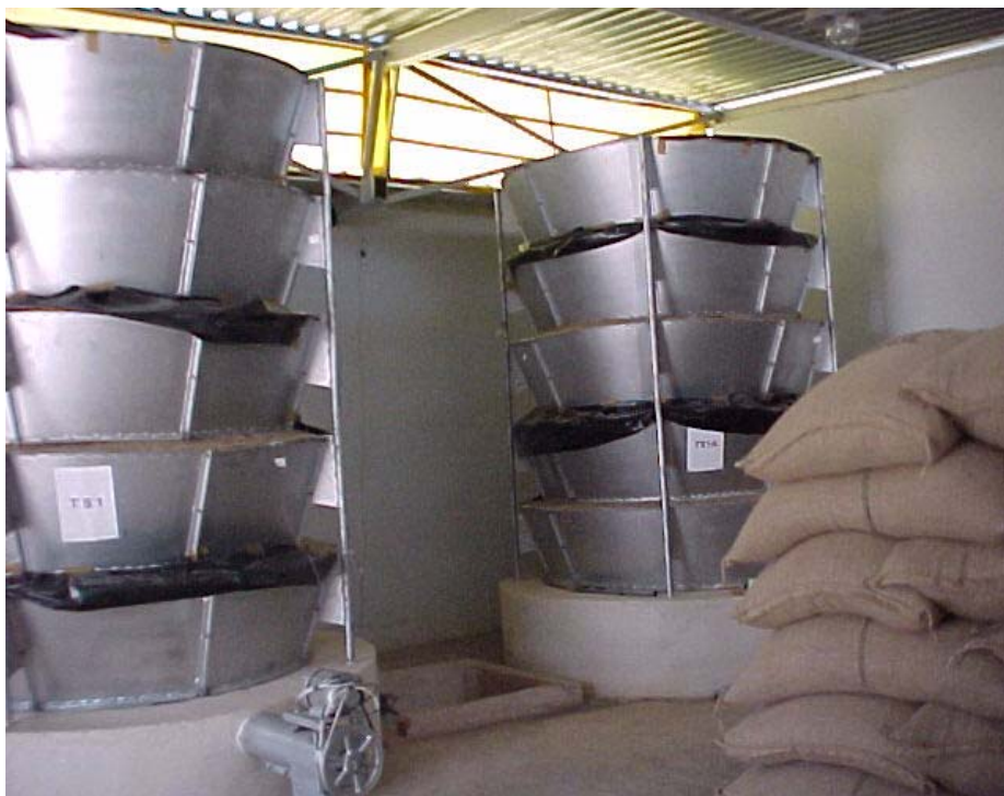
FIGURA 1 – Vista dos silos metálicos modulares móveis sem e com aeração e da pilha dos grãos armazenados em sacos de juta.
