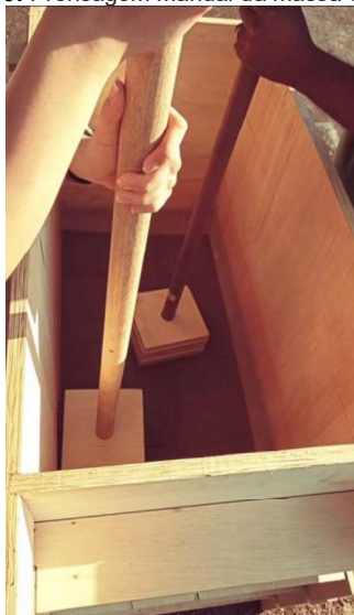
Figura 89: Prensagem manual da massa em fôrma
