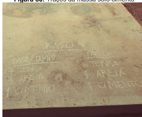
Figura 86: Traços da massa solo-cimento
