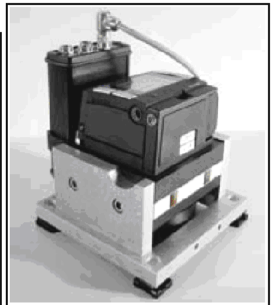
Fig 3.20 - Unidade de montagem da Rollei-Metric AIC Fonte: Hellmeier (2007)
