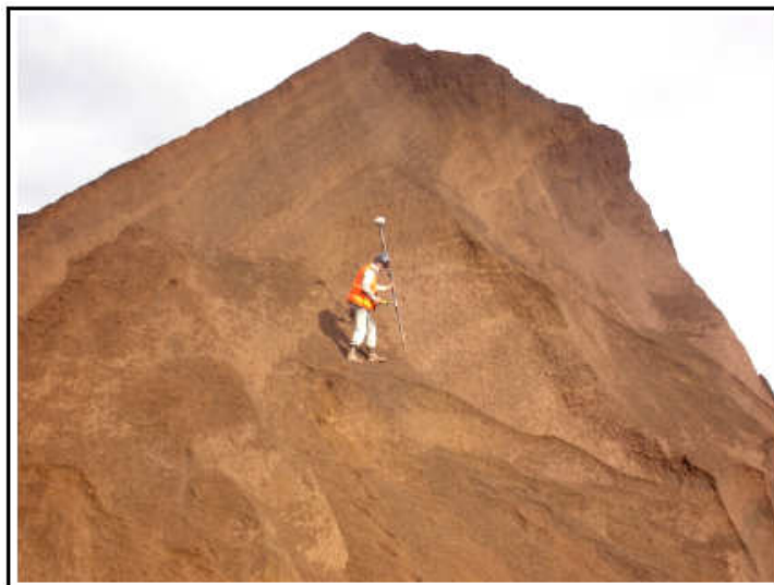
Fig 3.9 - Levantamento GPS para cálculo de volume de minério
